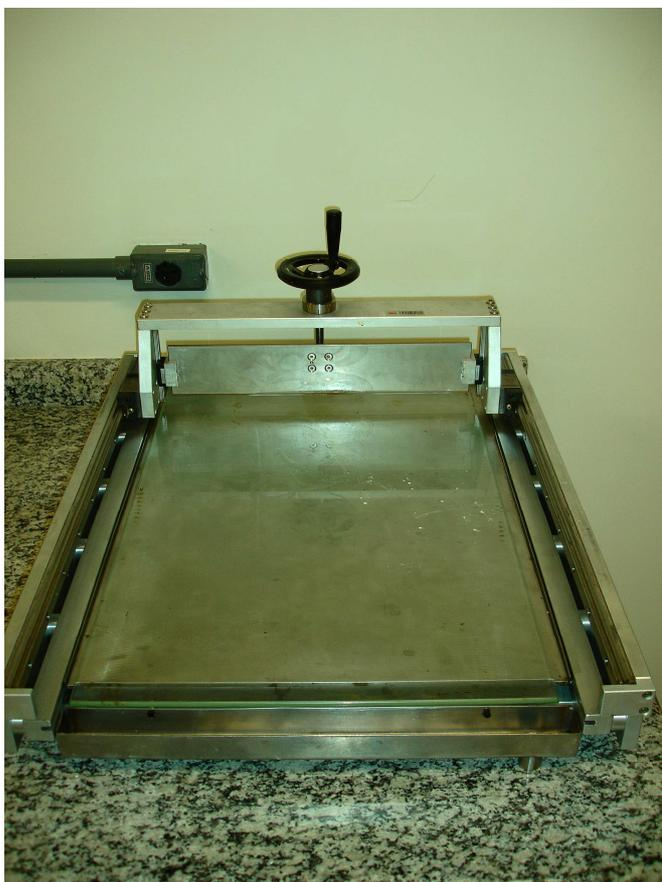
Figura 3.1: Dispositivo de formação de filme com controle micrométrico.
