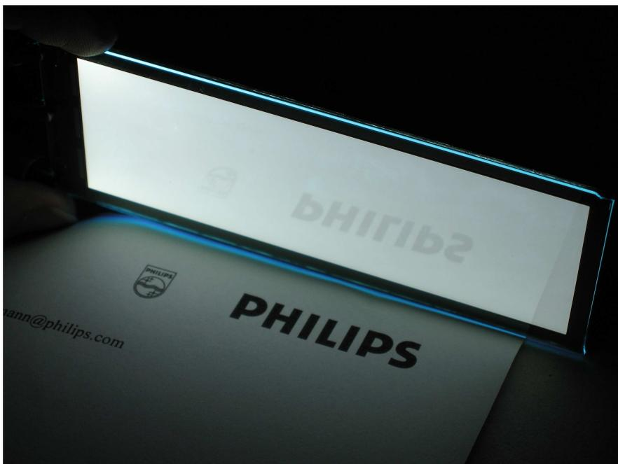
Figura 2.3: Telas com o uso de Díodo orgânico emissor de luz. <sup>[67]</sup>
