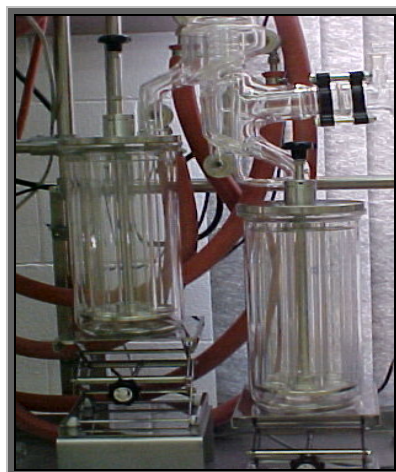
Figura III.3. Foto do conduto de vácuo e dos carrosséis coletores de resíduo e destilado do destilador molecular de filme descendente.
