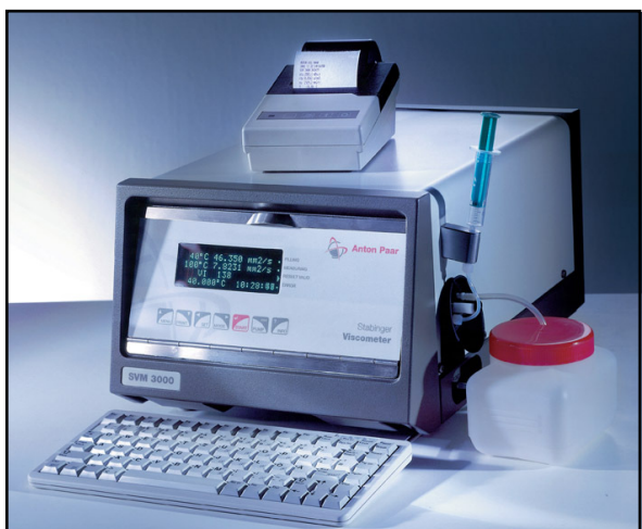
Figura IV.1. Viscosímetro Stabinger SVM 3000 usado para determinação das viscosidades dos cortes de destilado.
