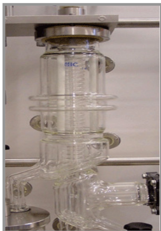
Figura III.2. Foto do evaporador e o condensador do destilador molecular de filme descendente.
