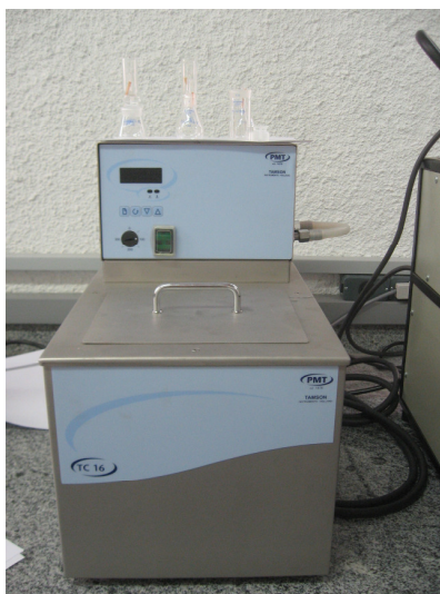
Figura IV.12. Foto do banho térmico TC16 para realizar os ensaios de massa específica pelo método do picnômetro.
