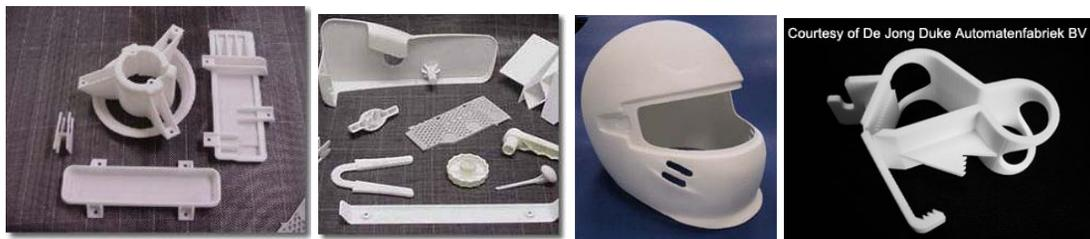
Figura II.12 – Modelos e protótipos em Nylon produzidos por SLS.
