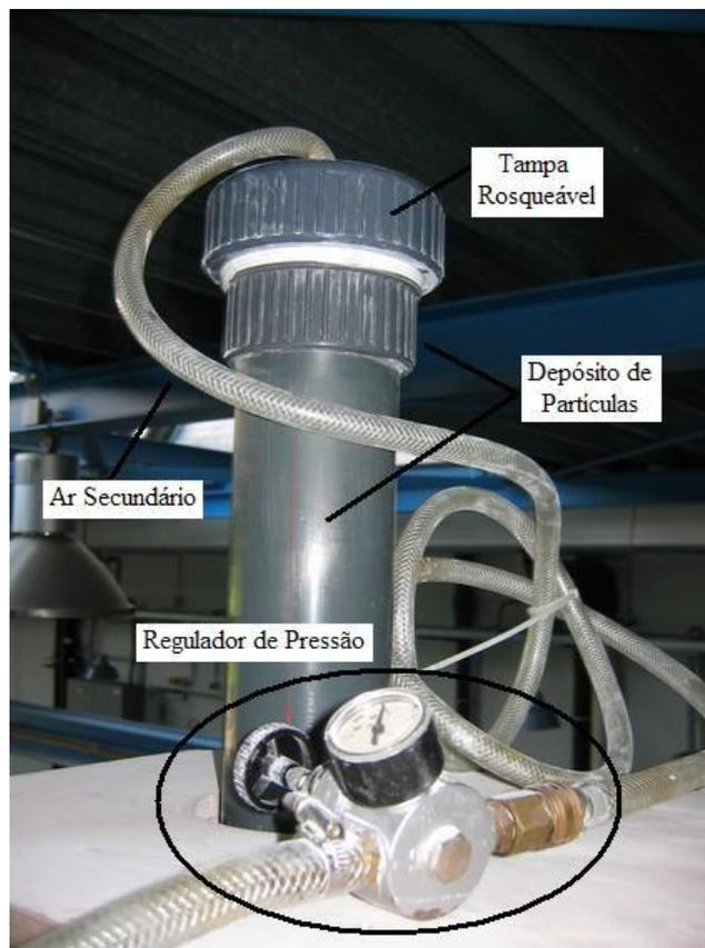
Figura 3.15. Depósito pressurizado de partículas.
