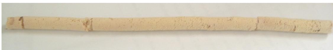
Figura 4.2 - Leito de partículas lavadas quatro vezes com etanol após o processo de extração utilizando CO<sub>2</sub> supercrítico à 80 °C e 350 bar como solvente.
