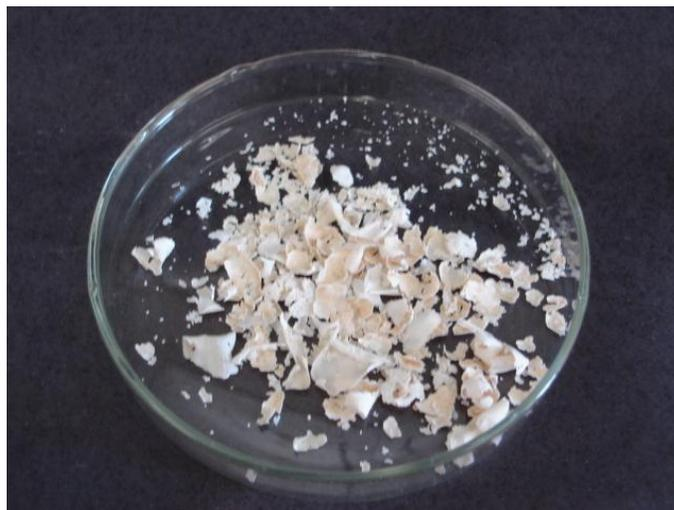
**Figura 43** - Aspecto macroscópico da membrana de acetato de celulose obtida por solubilização em acetona segundo metodologia de ALUIGI *et al.* (2008).
