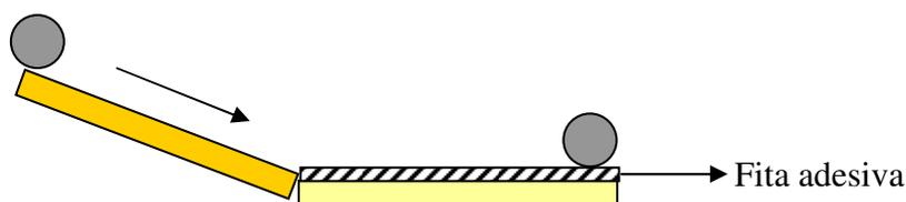
Figura 8 – Esquema de ensaio de Rolling Ball.
