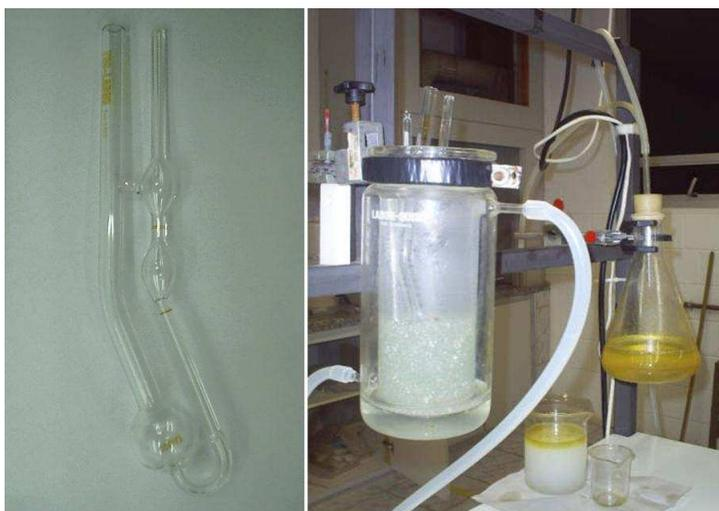
**Figura 18. Viscosímetro Cannon-Fenske 200 e aparatos para medição da viscosidade cinemática. (ROCHA, 2008)**
