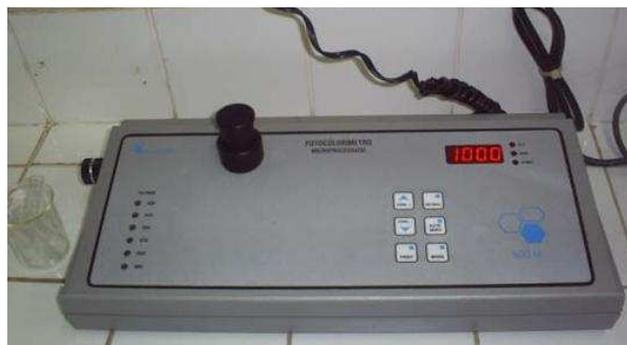
**Figura 19. Fotocolorímetro utilizado na obtenção da transmitância.**
