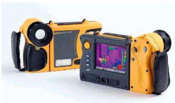
**Figura 17. Foto do Termógrafo infravermelho pertencente ao LOPCA/FEQ/UNICAMP.**
