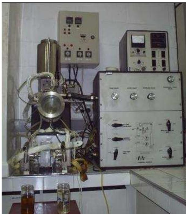
**Figura 15. Destilador Molecular Centrífugo, disponível no LDPS/LOPCA/FEQ/UNICAMP. (ROCHA, 2008)**
