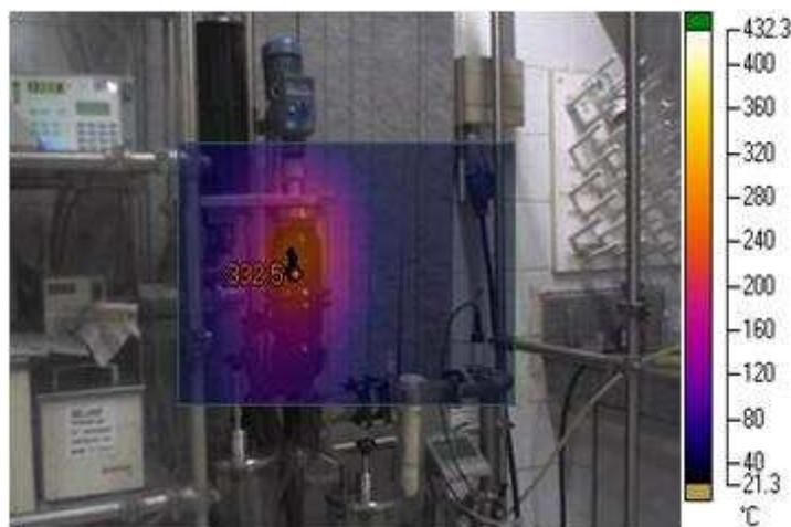
**Figura 62. Termograma em tempo real da DM do RV 565°C a uma T<sub>evap</sub> de 330°C**
