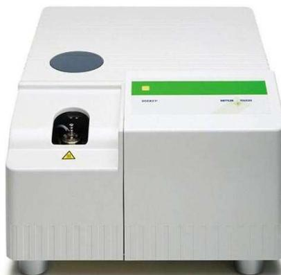
**Figura 21. Foto do Calorímetro diferencial de varredura DSC 823e pertencente ao LOPCA/FEQ/UNICAMP.**
