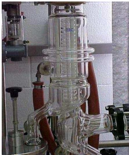
**Figura 11. Foto em detalhe do evaporador e condensador do destilador molecular de filme descendente pertencente ao LDPS/FEQ/UNICAMP.**
