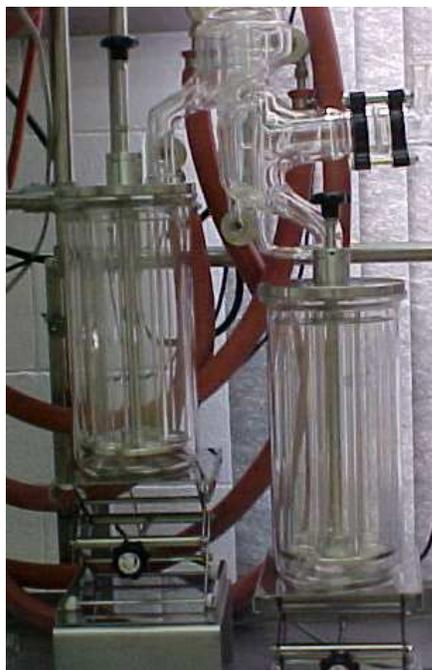
**Figura 14. Foto em detalhe dos carrosséis coletores de resíduo e destilado do destilador molecular de filme descendente pertencente ao LDPS/FEQ/UNICAMP.**
