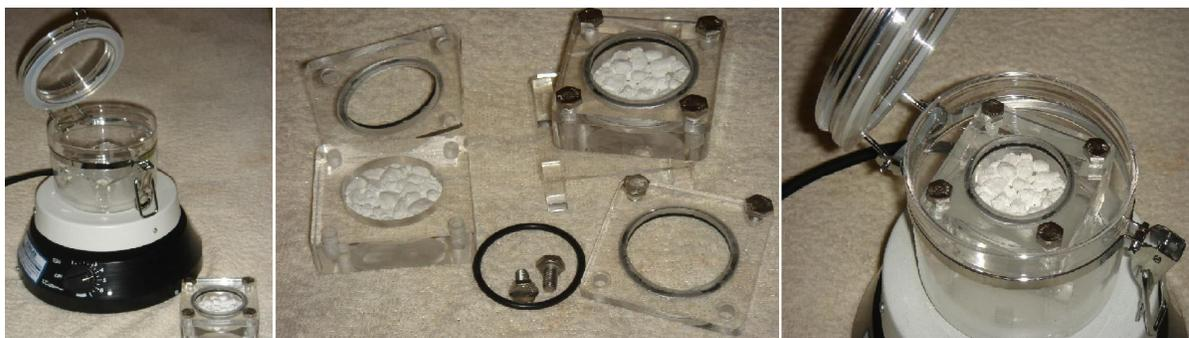
Figura 3.4: Células de PVA em acrílico
