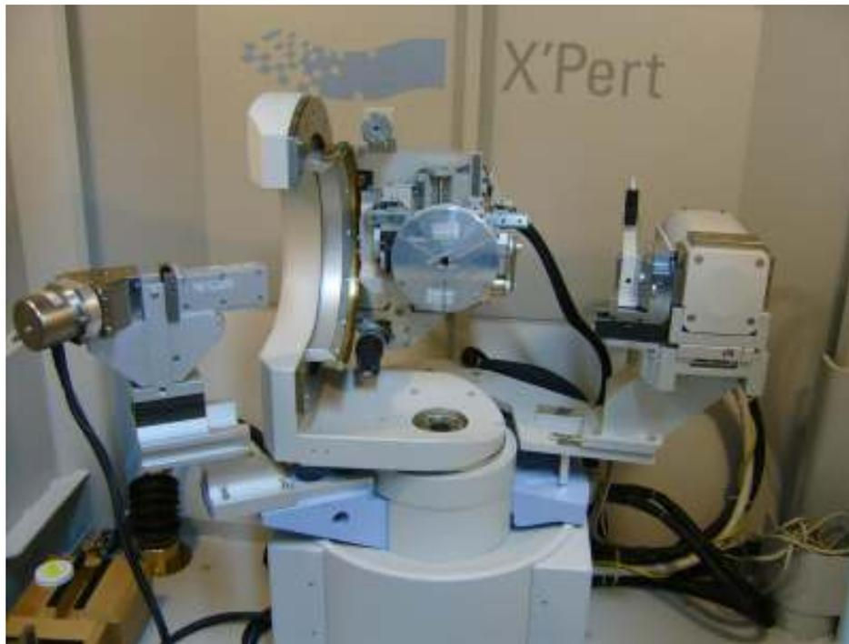
Figura 3.2 – Difratorômetro de Raios-X Philips X'Pert PRO MRD com tubo de ânodo de cobre.
