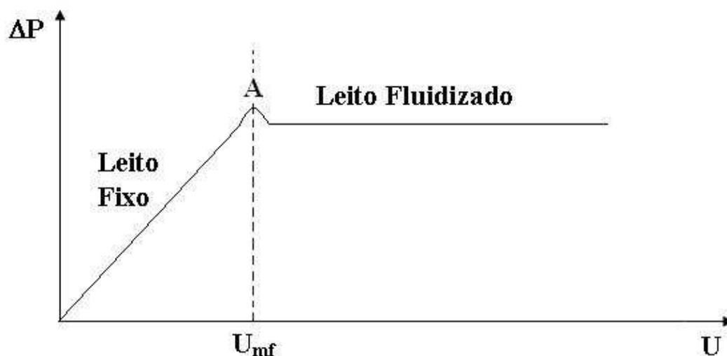
**Figura 2.3 Esquema da queda de pressão em função da vazão de ar para um leito fluidizado convencional.**
