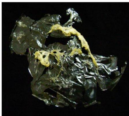
Figura 4.3: Aspecto da membrana preparada com quitosana a 0,5% (m/v) e carragena a 0,5% (m/v).
