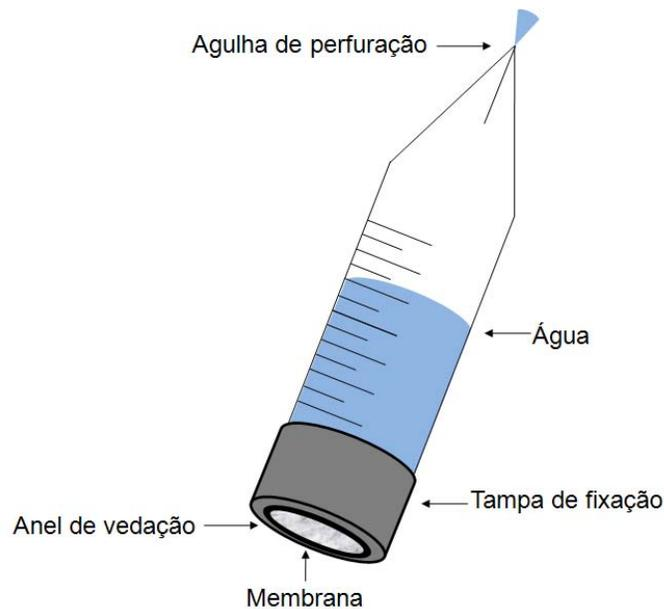
Figura 3.2: Dispositivo empregado para a avaliação da capacidade de drenagem de água das membranas.
