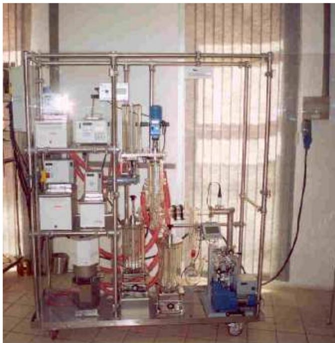
**Figura 3.1** – Foto do destilador molecular de filme descendente pertencente ao LOPCA/LDPS/FEQ/UNICAMP.
