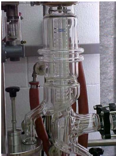
**Figura 3.2** – Visão interna do evaporador e condensador do destilador molecular de filme descendente.
