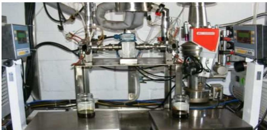
**Figura 3.7** – Sistema de coleta de resíduo e destilado.
