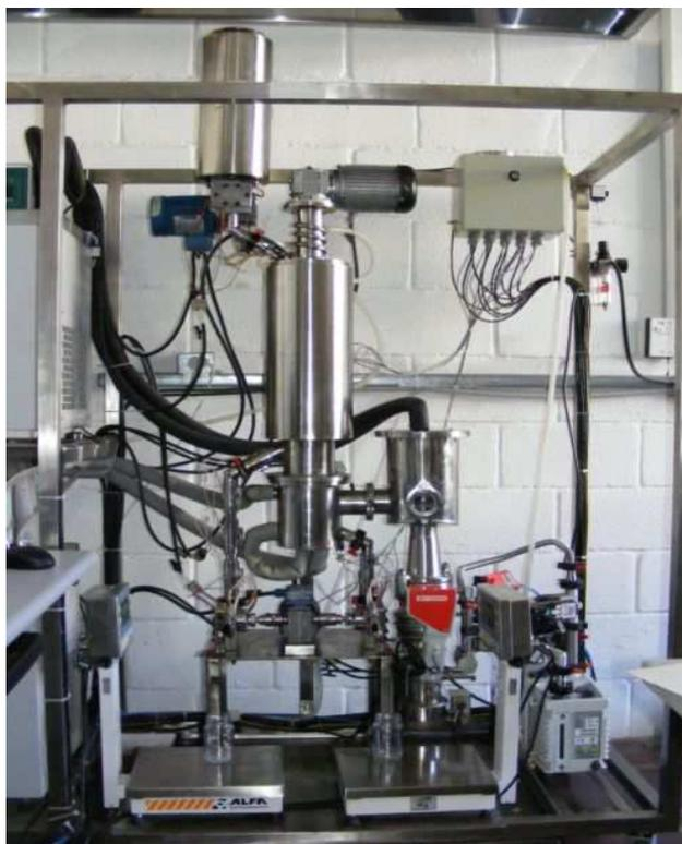
**Figura 3.4** – Foto do protótipo nacional de destilador molecular de filme descendente pertencente ao LOPCA/LDPS/FEQ/UNICAMP.
