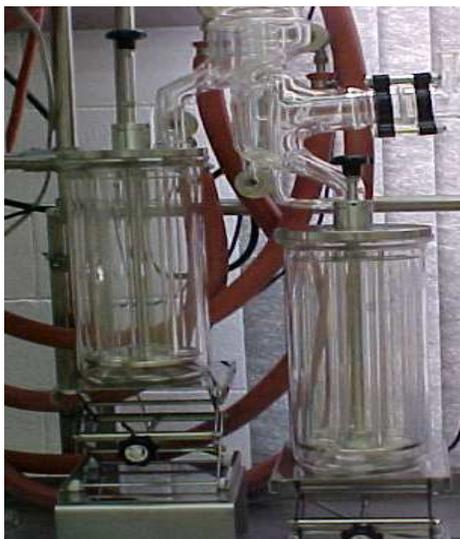
**Figura 3.3** – Foto em detalhe dos carrosséis coletores de resíduo e destilado do destilador molecular de filme descendente.
