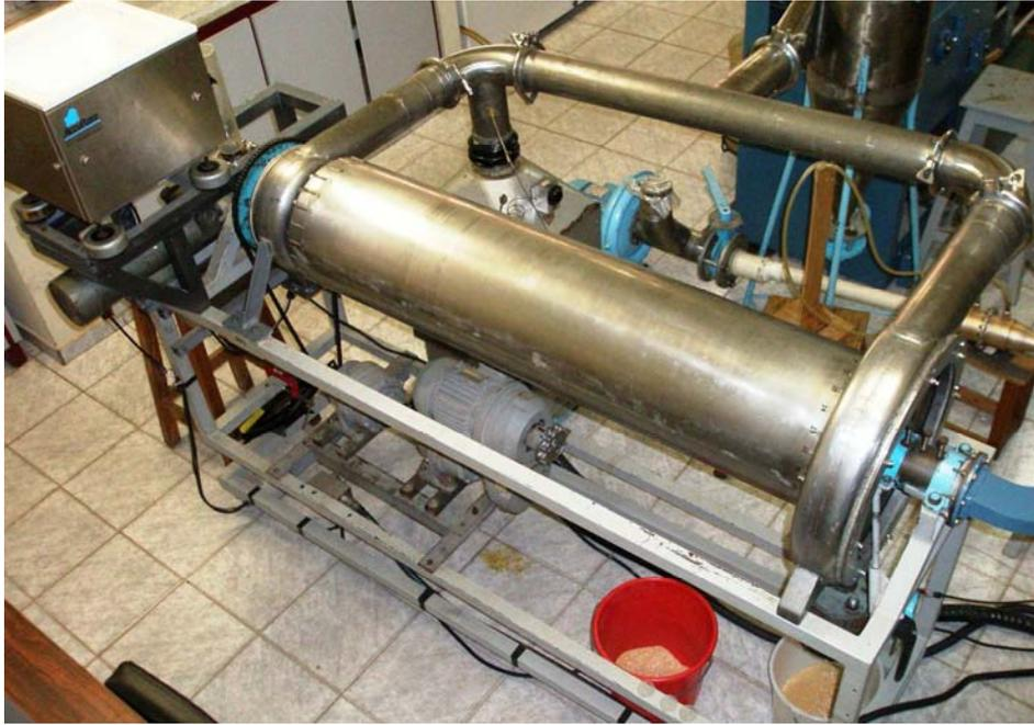
Figura 3.6 - Secador de cilindro rotativo com aplicação de microondas
