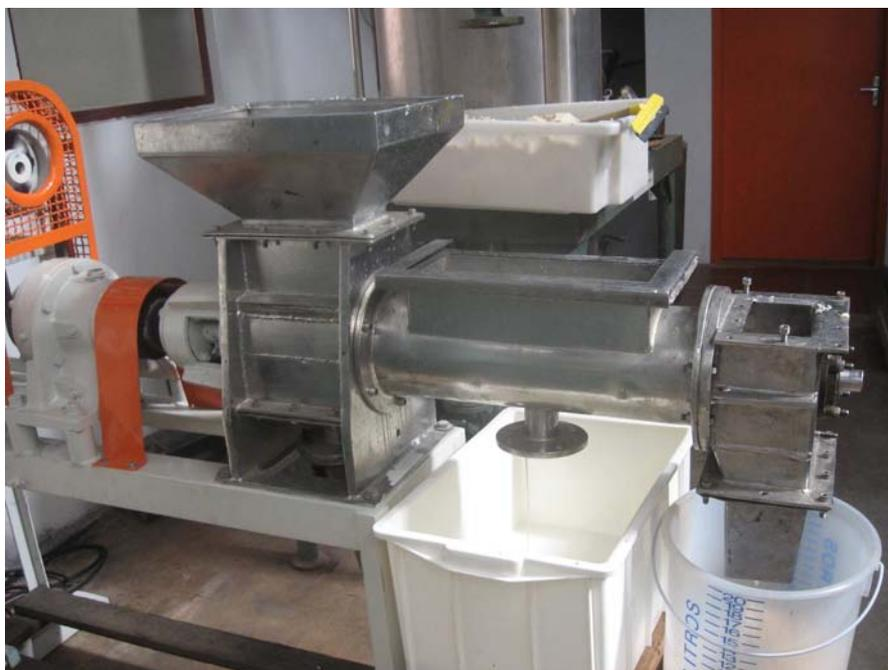
Figura 3.2 - Prensa helicoidal horizontal contínua
