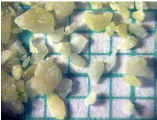
Figura 4.31 - Okara seco em cilindro rotativo com aplicação de microondas
