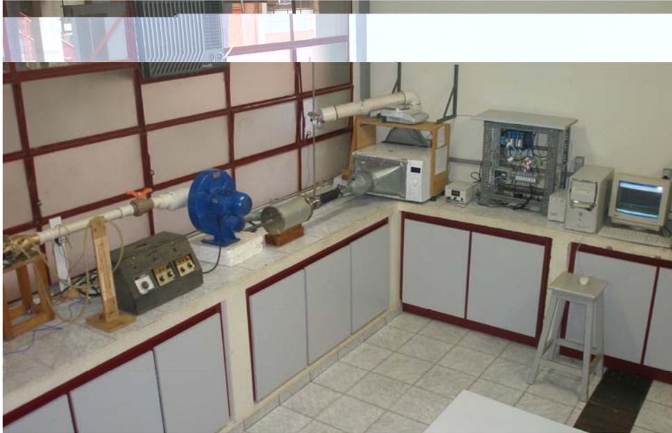
Figura 3.7 - Secador de forno de microondas adaptado com circulação de ar quente
