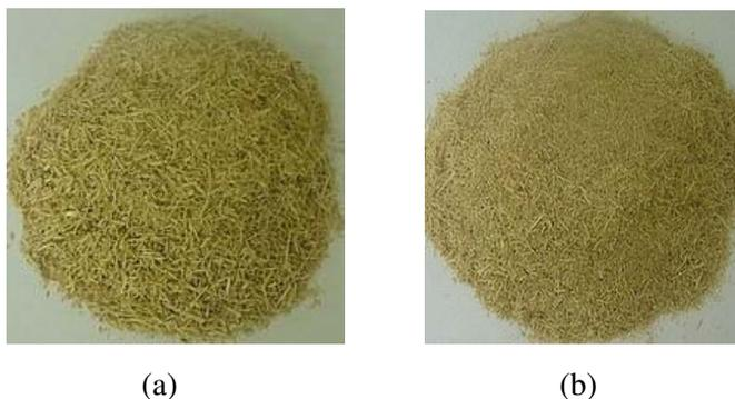
Figura 3.1: (a) Bagaço moído e não peneirado e (b) Bagaço moído e peneirado.
