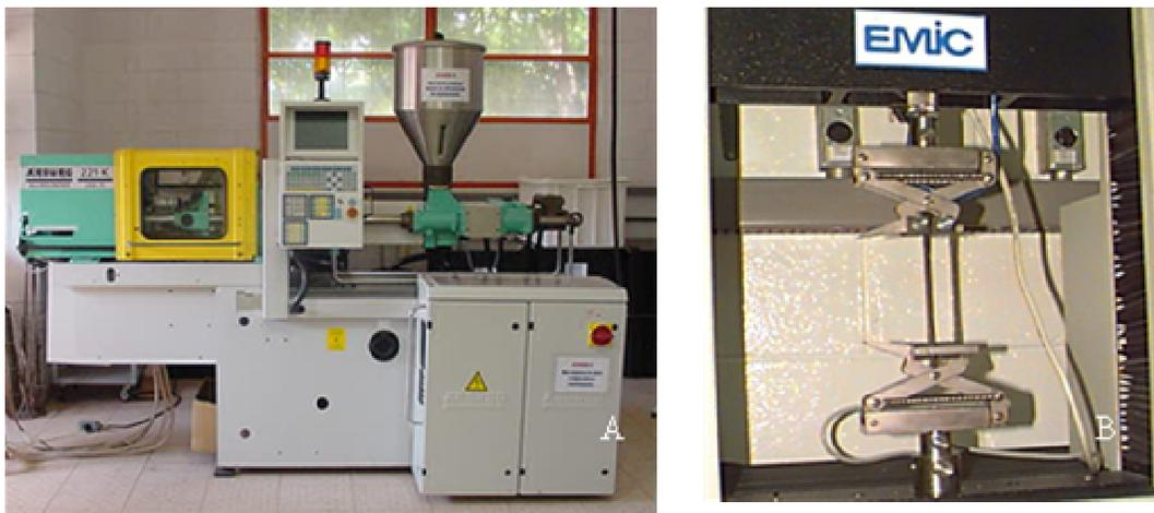
**Figura V.37 - (A) Injetora Arburg Allrounder 221M 250-55 e (B) Máquina universal de ensaios EMIC DL 2000 (Tração).**
