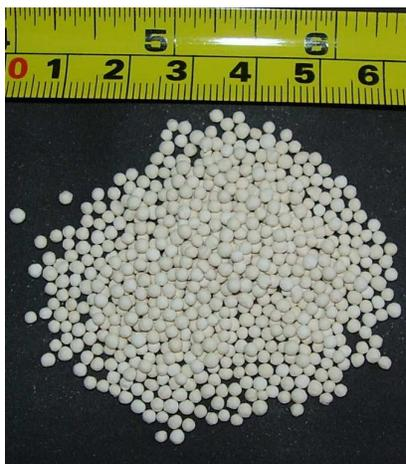
**Figura 91:** Zeólita sintética utilizada nos testes
