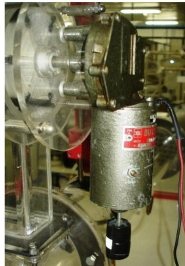
Figura 3.14 – Motor da válvula rotativa
