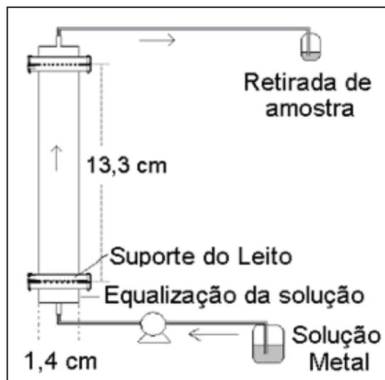
Figura 4.3 - Esquema do leito poroso.
