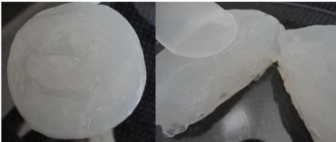
Figura 11 – Fotos do hidrogel de glucomanana com 10 dias, obtido no ponto central (Concentração de KGM = 2 %; Concentração da solução  $\text{Ca}(\text{OH})_2$  = 0,2 mol/L; Temperatura = 65 °C).
