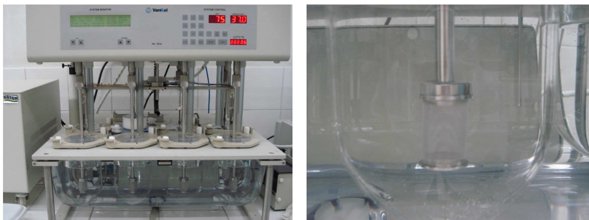
(a) (b) Figura 4.6. Dissolutor (a); aparato I (b).
