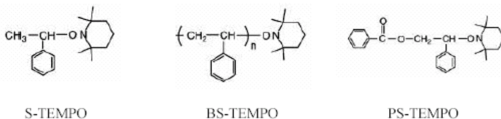
Figura 3.2: Tipos de iniciadores-controladores.
