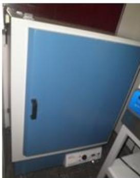
Figura 37. Estufa de secado estático com circulação e renovação de ar marca SP Labor, modelo SP-102/336.
