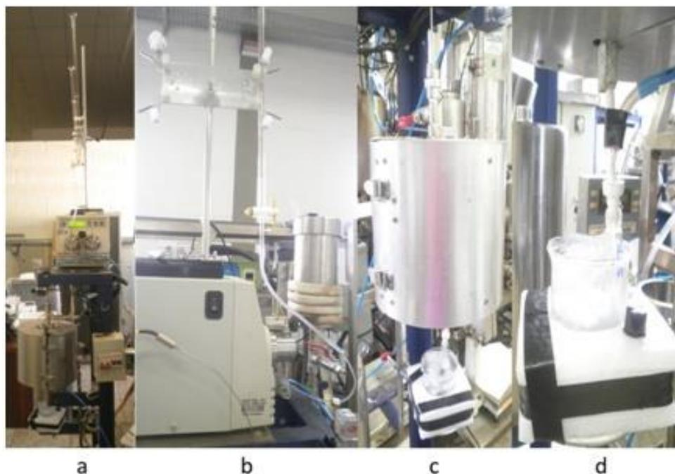
Figura 41. a) Equipamento usado na desidratação do ácido láctico; b) Sistema de alimentação; c) Reator tubular coberto com um revestimento de aquecimento; d) sistema de esfriamento.
