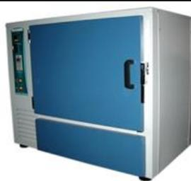
Figura 32. Câmara Incubadora Refrigerada com Agitação Orbital (*Shaker*) marca MARCONI, modelo MA 832.
