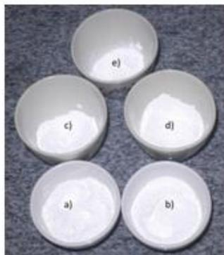
Figura 57. Catalisadores usados na desidratação do ácido láctico: a) NaY comercial, b) NaY modificado, c) KBr/NaY, d) KI/NaY e e)  $\text{Ca}_3(\text{PO}_4)_2/\text{NaY}$ .
