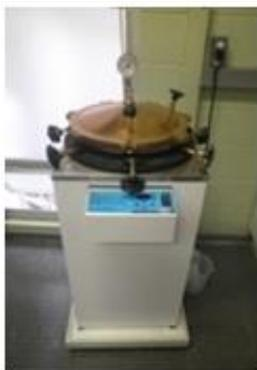
Figura 29. Autoclave Phoenix Lufanco modelo. AV-50 PLUS.
