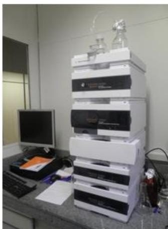
Figura 36. Cromatógrafo Agilent, modelo 1260 *Infinity Quaternary LC System*.
