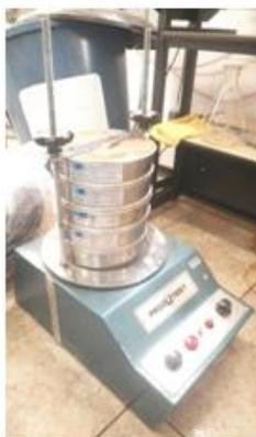
Figura 38. Peneirador marca Produtest.
