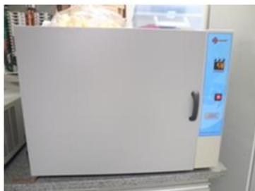
Figura 30. Estufa microprocessada de cultura e bacteriologia marca QUIMIS, modelo Q316M5.
