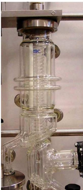
Figura 3.2: Foto em detalhe do destilador molecular de filme descendente em vidro
