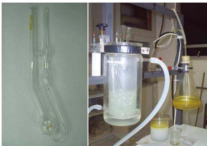
Figura 3.12: Viscosímetro Cannon-Fenske 200 e aparatos para medição da viscosidade cinemática
