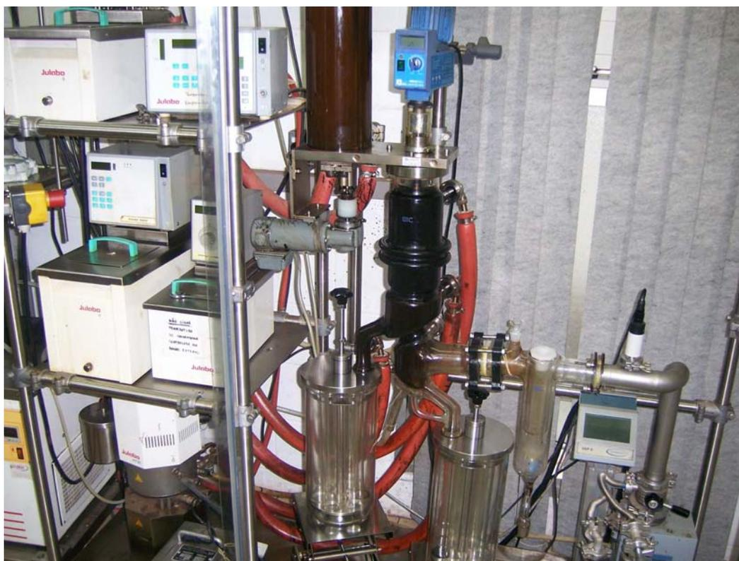
Figura 3.1: Destilador molecular de filme descendente em vidro, pertencente ao Laboratório de Desenvolvimento de Processos de Separação (LDPS)
