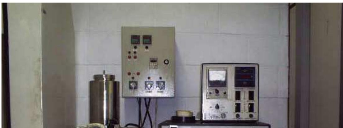
Figura 3.8: No lado esquerdo, o tanque de armazenamento; ao lado do tanque, o controlador de temperatura e vazão; e no lado direito o controle de acionamento das bombas de vácuo e leitura da pressão na região do evaporador
