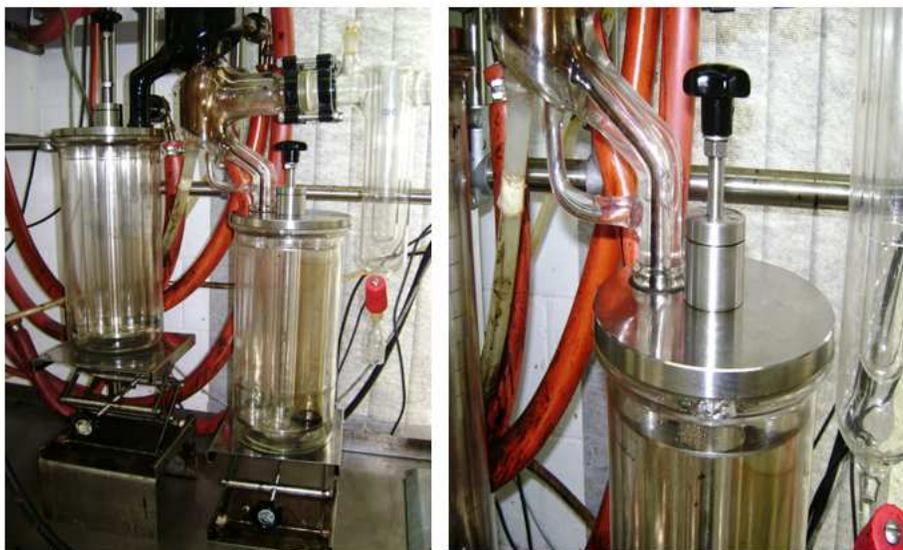
Figura 3.4: Foto em detalhe (lado esquerdo) dos carrosséis coletores dos cortes e resíduos do destilador molecular de filme descendente em vidro. No lado direito, detalhe na coleta do destilado
