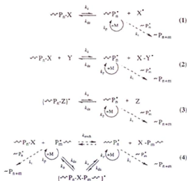
Figura 7: Mecanismos para polimerização controlada
