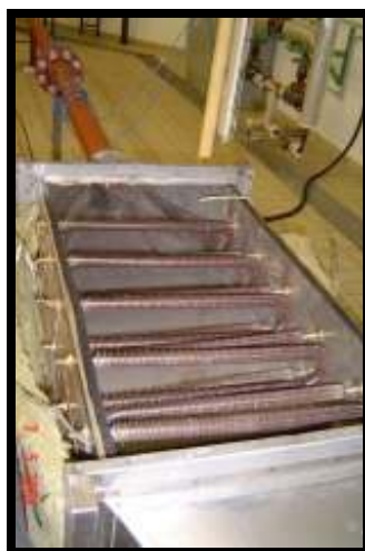
Figura 3.7 - Vista do conjunto de resistências elétricas.
