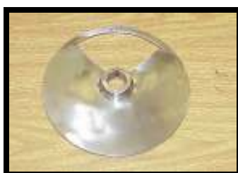
Figura 3.12 - Disco rotativo, peça responsável pelo redirecionamento da corrente gasosa.
