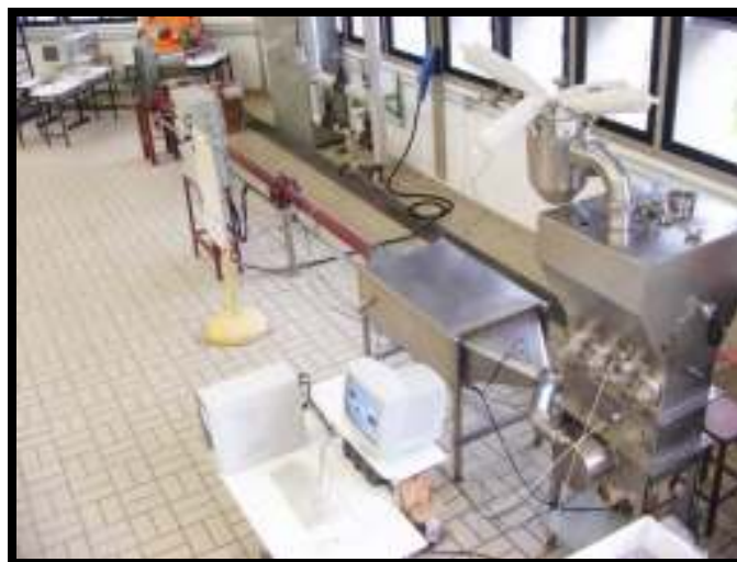
Figura 3.3 - Fotografia do Leito Pulso-Fluidizado (à direita) e periféricos.
