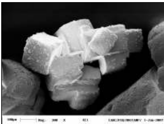
Figura 4.5 – Cloreto de potássio, ampliação 300 ×
