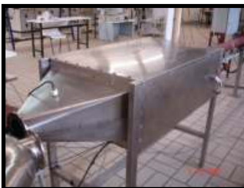
Figura 3.6 – Caixa de inox com isolamento de lã de vidro, onde estão instaladas as resistências elétricas.
