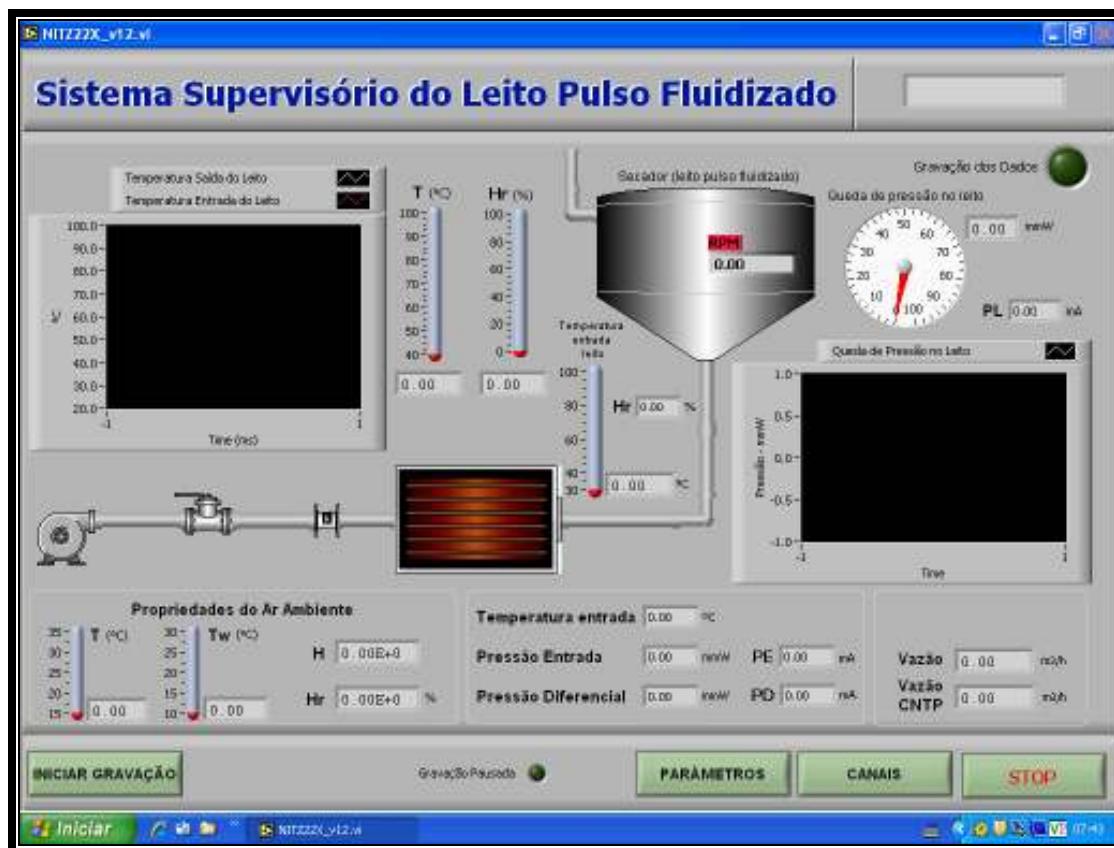
Figura 3.17 - Tela gerada pelo aplicativo de supervisão e aquisição de dados da operação.
