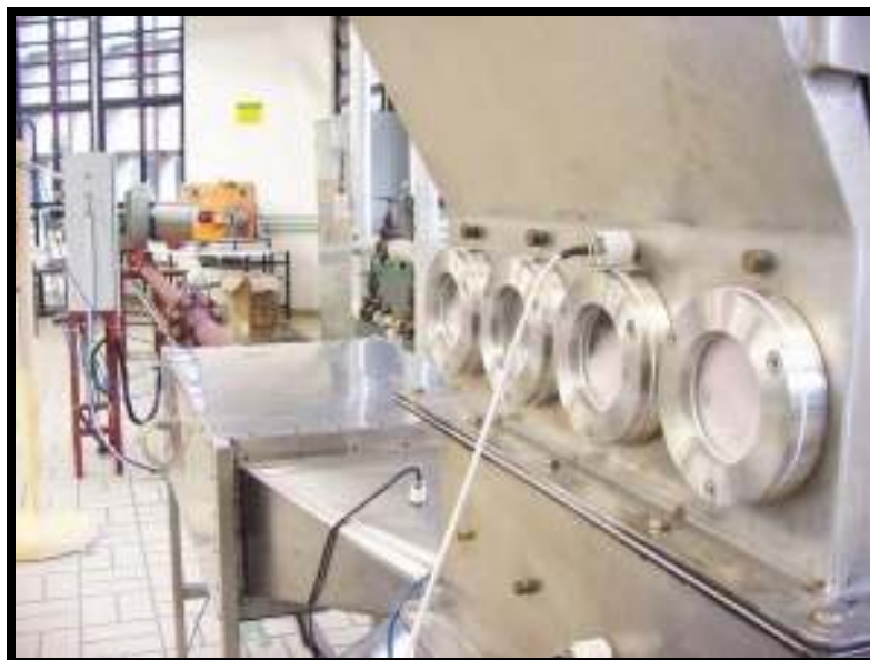
Figura 3.8 – primeiro plano: leito de seção retangular e visores de vidro temperado.
