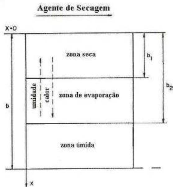
Figura 2.7 - Zonas de secagem em um material secando (STRUMILLO & KUDRA, 1986).
