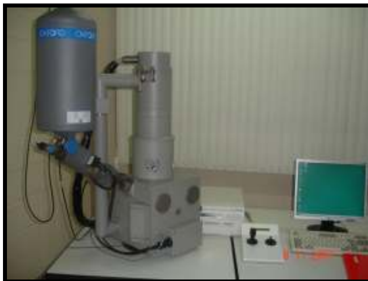
Figura 3.1 – Fotografia do Microscópio Eletrônico de Varredura (MEV), modelo 440i.
