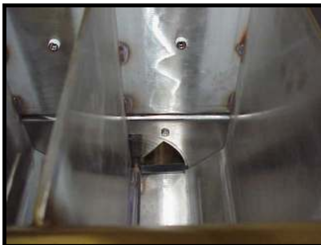
Figura 3.15 - Vista interna da câmara de distribuição do ar. No centro da figura, é visível a abertura do disco rotativo.
