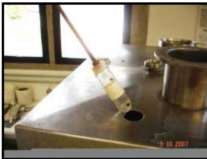
Figura 3.19 – Procedimento de amostragem durante o processo de secagem
