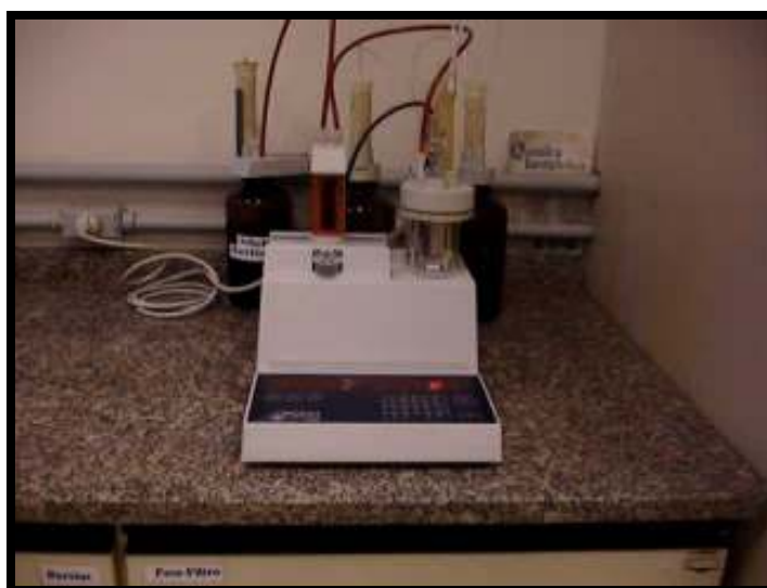
Figura 3.20 - Karl-Fischer: equipamento para determinação do conteúdo de umidade.
