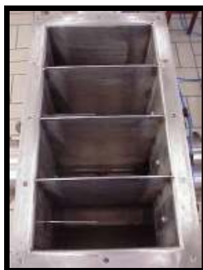
Figura 3.11. Câmara de distribuição de ar com 4 seções.
