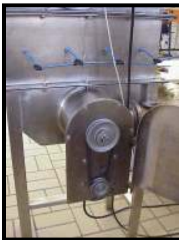
Figura 3.13 - Polias e correia, partes do sistema de pulsação da corrente gasosa.
