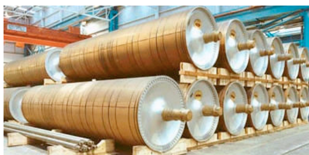
Figura 2.8: Cilindros a vapor para a secagem de papel (Bracelpa, 2003).
