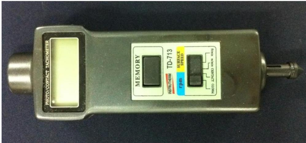
Figura 31 – Tacômetro (precisão de 1 .rpm).
