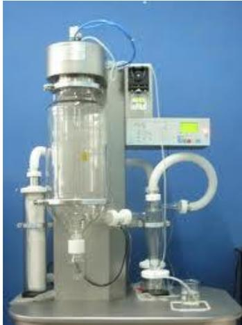
Figura 19 - *Spray dryer* em escala de laboratório (ADL, 2012)
