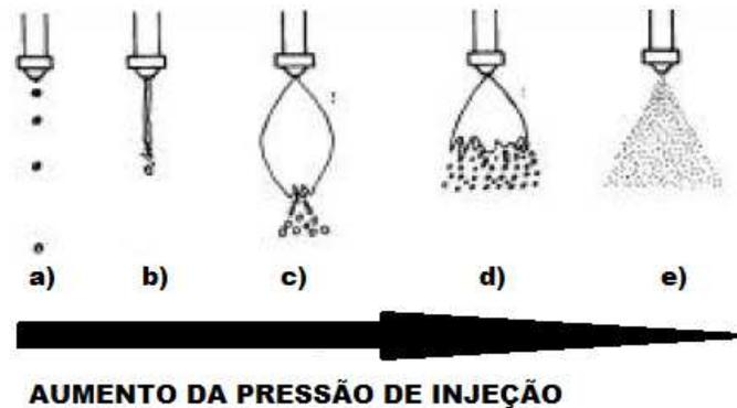
(a) a pressão é muito próximo de zero, (b) o líquido deixa o orifício na forma de um cilindro distorcido, (c) forma-se um cone junto do orifício que se contrai sob a ação da tensão superficial (cebola), (d) a película (tulipa) rompe-se em gotas formando um *spray* grosseiro e (e) obtém-se o *spray* plenamente desenvolvido.
