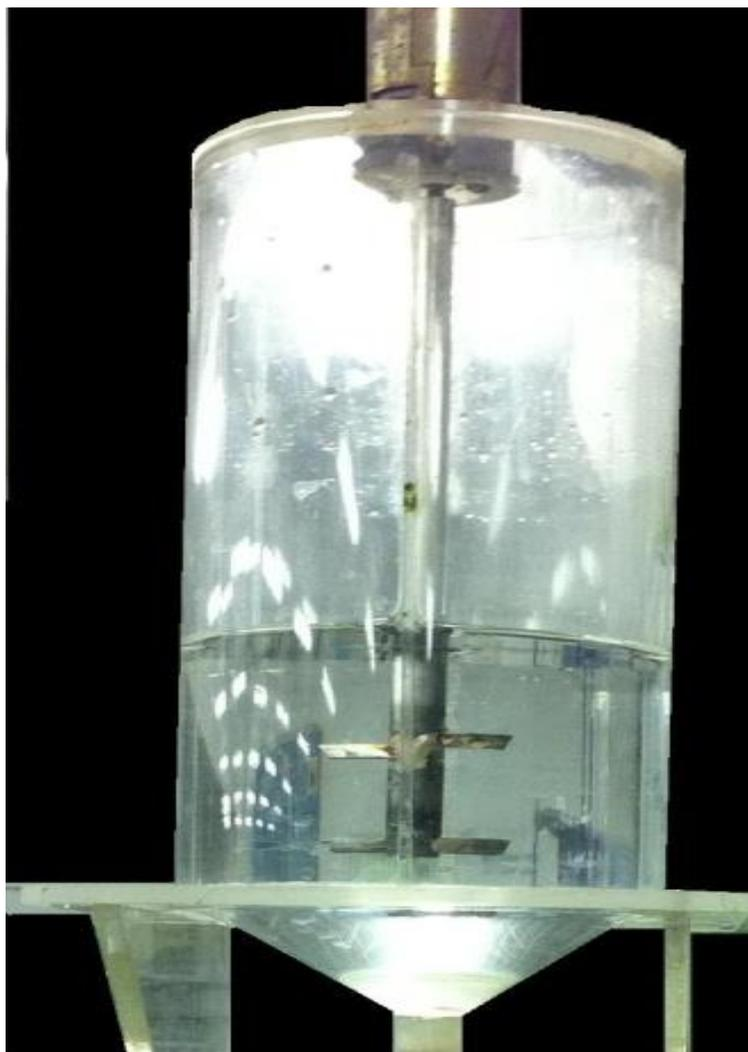
Figura 24 - Tanque de alimentação.
