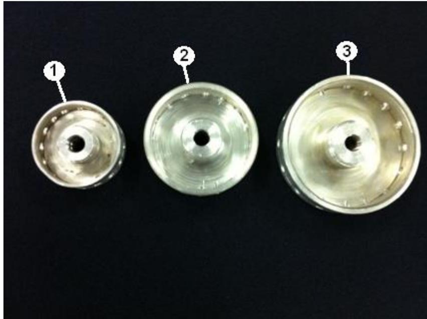
Figura 27 - Discos atomizadores. 1) Disco Atomizador com diâmetro ( $\emptyset$ ) externo de 30 mm; 2) Disco Atomizador com diâmetro ( $\emptyset$ ) externo de 40 mm; 3) Disco Atomizador com diâmetro ( $\emptyset$ ) externo de 50 mm.
