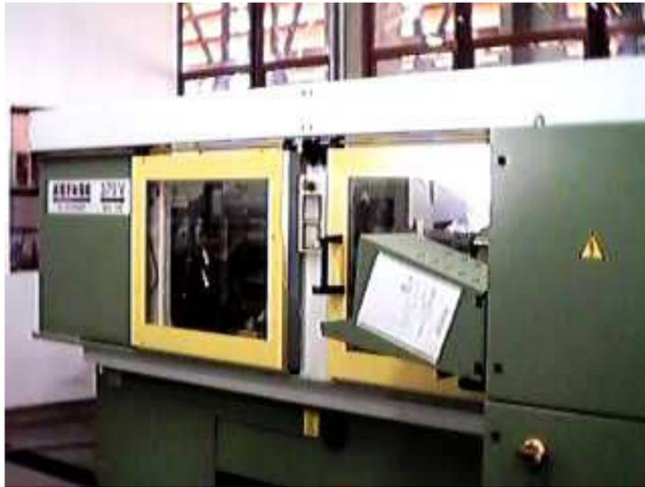
Figura 26: Injetora Arburg Allrounder 270V/300-120 alocada no Núcleo de Reologia e Processamento de Polímeros ( NRPP ) - ( DEMa/UFSCar ).
