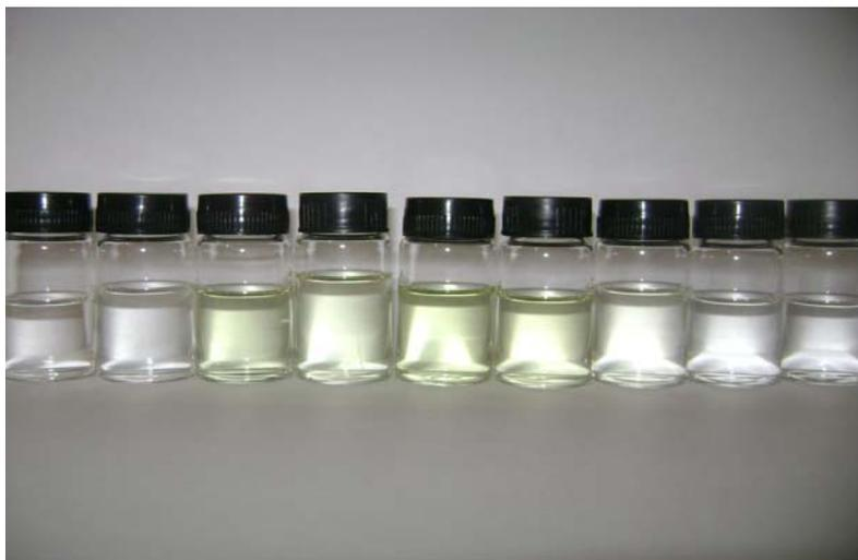
**Figura IV.30.** Fotografia das amostras obtidas na etapa de dessorção com CO<sub>2</sub> + 10% etanol.
