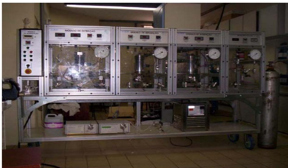
**Figura III.1.** Equipamento de extração supercrítica.
