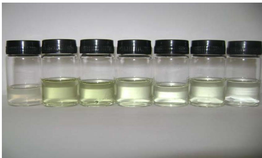
**Figura IV.3.** Fotografia das amostras obtidas em cada ponto da extração realizada com folhas de jaborandi utilizando CO<sub>2</sub> puro.
