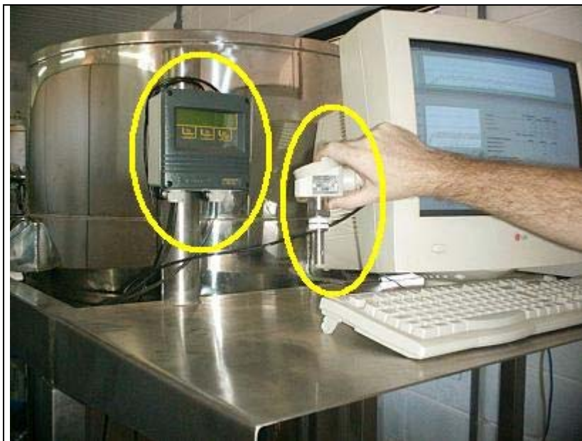
Figura 27 – Medidor de condutividade elétrica de amostras, marca DIGIMED.
