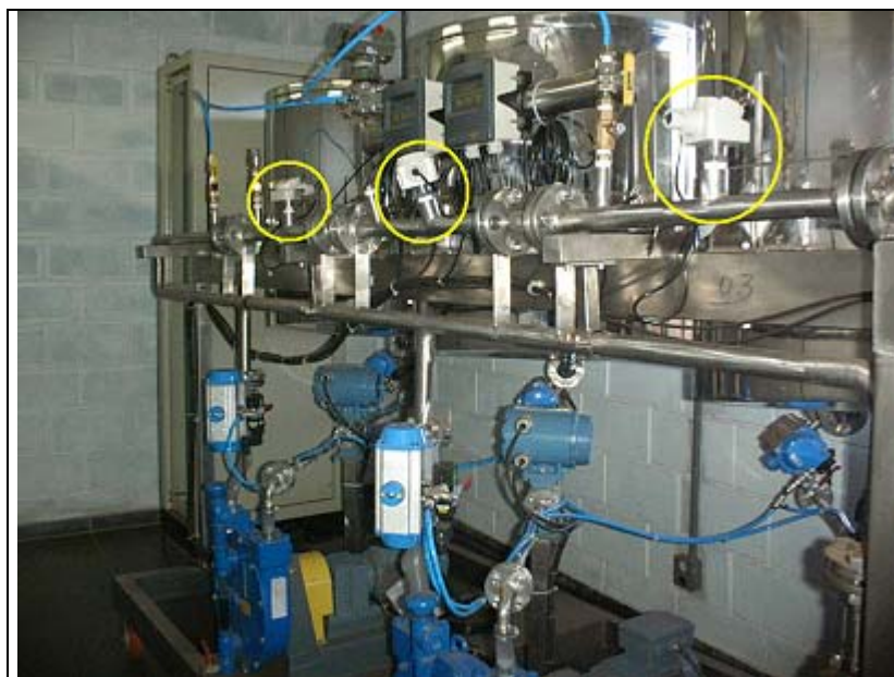
Figura 20 – 03 Pontos de tomada de condutividade elétrica, em destaque.
