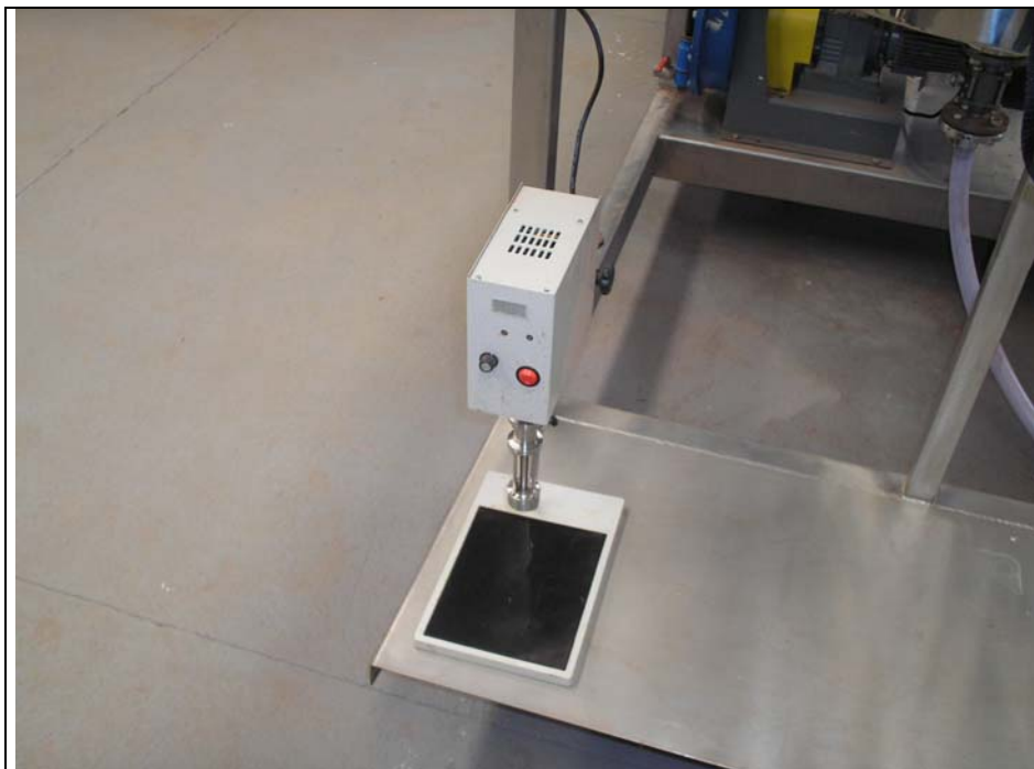
Figura 29 – Misturador de bancada – utilizado para misturar as amostras com concentrações conhecidas dos produtos utilizados.
