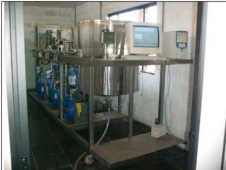
Figura 10 – “Skid” de suporte da bancada (com tanque de produto final de 750 litros em primeiro plano).
