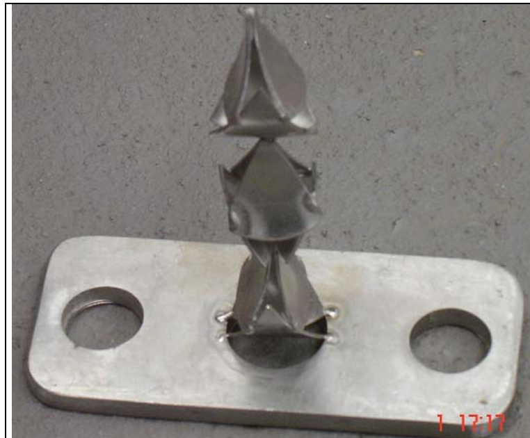
Figura 32 – Um dos três misturadores estáticos tipo escamas dupla A modificado (EDA) ensaiados na bancada de testes.
