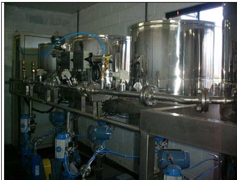
Figura 11 – 03 Tanques para componentes, com capacidade de 250 litros cada um.
