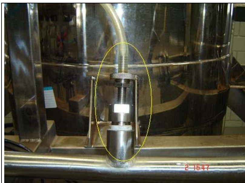
Figura 28 – Coletor de amostras com regulagem vertical, fabricado na KROMA.
