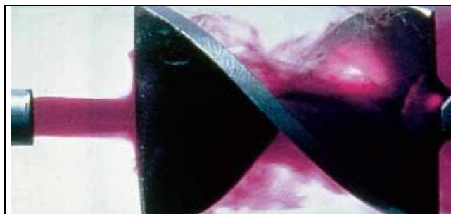
Figura 8 – Foto da geração de turbulência – mecanismo de mistura para regime turbulento.
