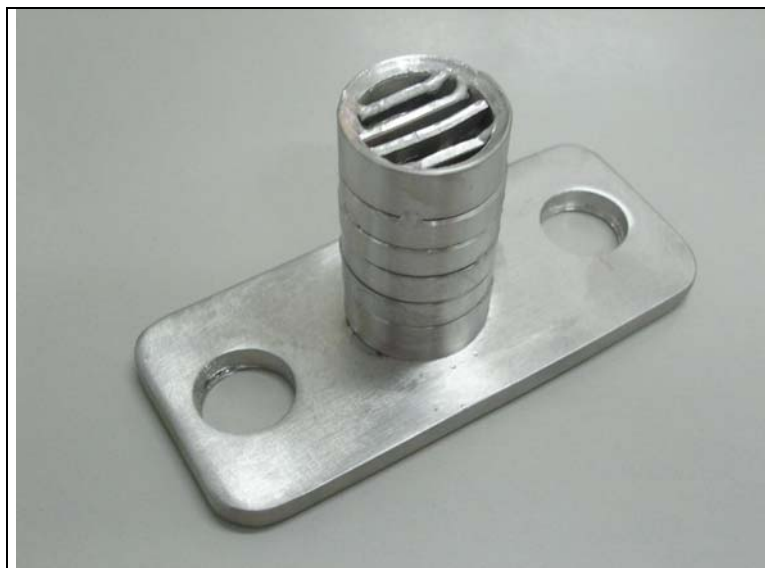
Figura 31 – Um dos três misturadores estáticos tipo ALETAS ensaiados na bancada de testes.
