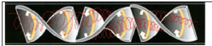
Figura 7 – Desenho esquemático da geração de turbulência – mecanismo de mistura para regime turbulento.
