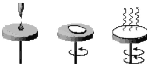
**Figura 19-Funcionamento do *Spin-Coating*** [84].
