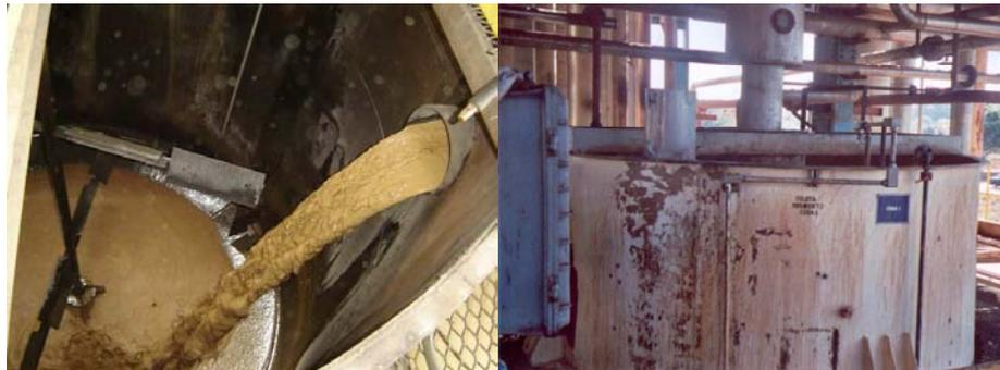
Figura 7: Tanque de inóculo (fermento) para o processo de produção de álcool.
