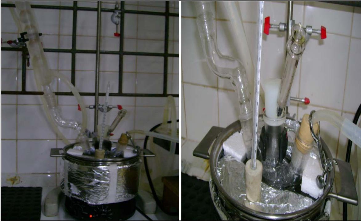
**Figura 6. Equipamento experimental para copolimerização em miniemulsão**
