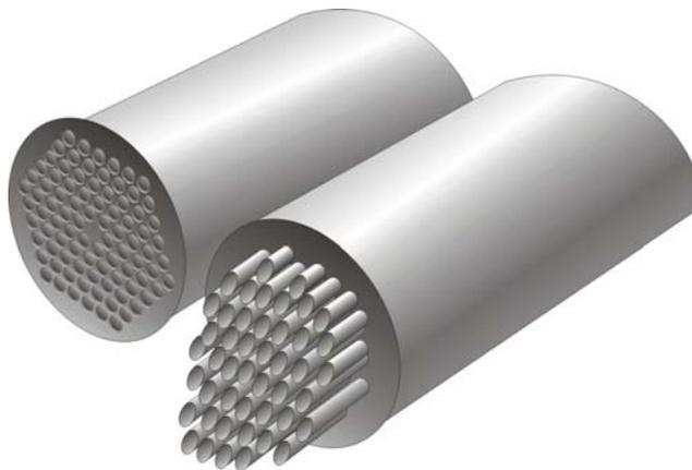
**FIGURA 7.** Representação esquemática de uma membrana com configuração tubular multicanal.
