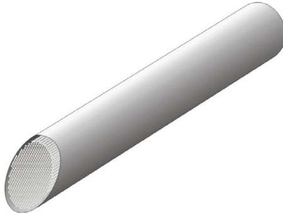
**FIGURA 6.** Representação esquemática de uma membrana com configuração fibra oca ou capilar.
