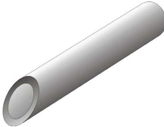
**FIGURA 8.** Representação esquemática de uma membrana com configuração tubular monocanal.
