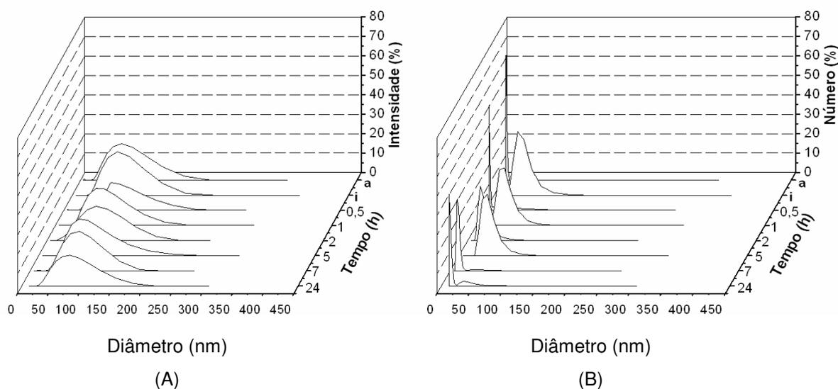
Figura 38 – Influência do tempo no diâmetro e distribuição de tamanhos dos lipossomas elásticos (25 % PEG-8L), após permeação em 12 atm e 37<sup>0</sup> C, durante 24 horas, em termos de (A): intensidade de luz espalhada e (B): número de partículas.
