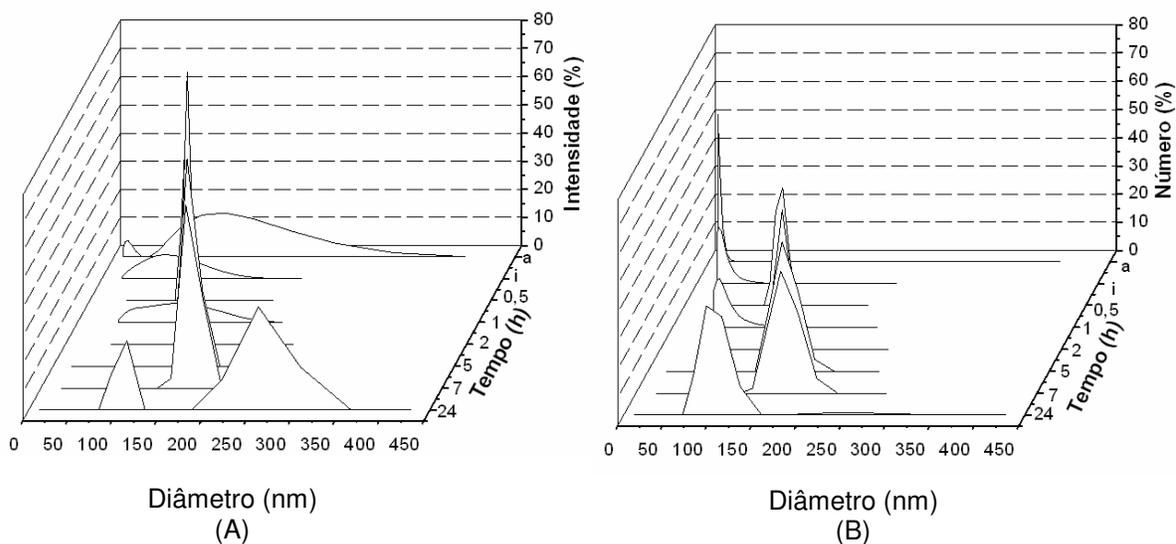
Figura 35 – Influência do tempo no diâmetro e distribuição de tamanhos da solução de PEG-8-L puro em solução, na concentração de  $1.10^{-3} \text{ mol.L}^{-1}$ , em 20 atm e  $37^{\circ} \text{ C}$ , durante 24 horas, em termos de (A): intensidade de luz espalhada e (B): número de partículas.
