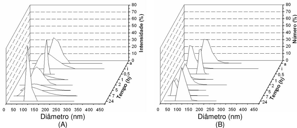
Figura 27 – Influência do tempo no diâmetro e distribuição de tamanhos das vesículas lipídicas, após permeação em 5 atm e 37<sup>0</sup> C, durante 24 horas, em termos de (A): intensidade de luz espalhada e (B): número de partículas.
