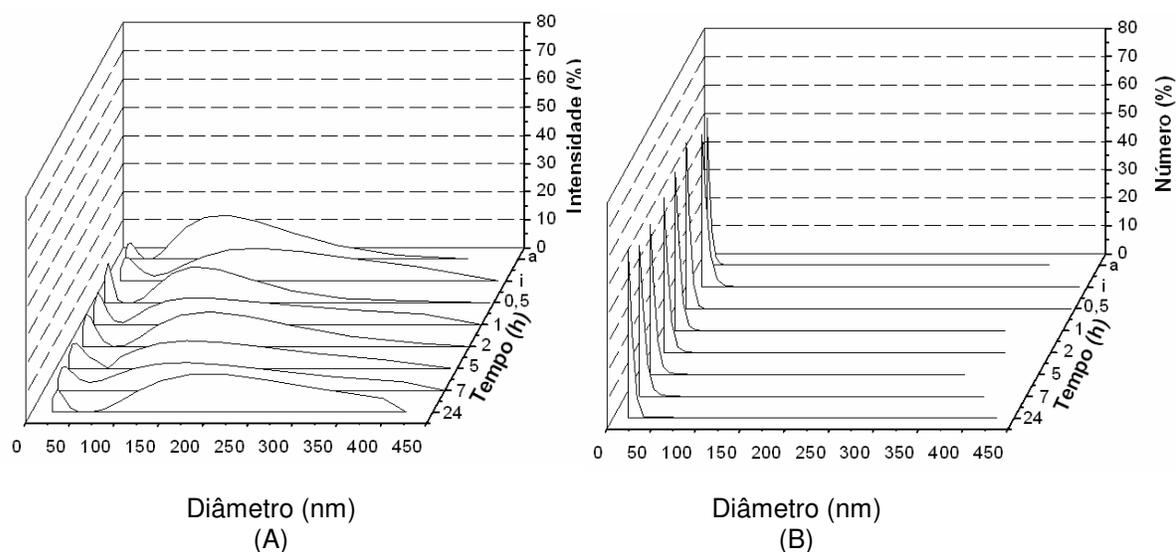
Figura 33 – Influência do tempo no diâmetro e distribuição de tamanhos da solução de PEG-8-L puro, na concentração de  $1 \cdot 10^{-3} \text{ mol} \cdot \text{L}^{-1}$ , em 12 atm e  $37^{\circ} \text{ C}$ , durante 24 horas, em termos de (A): intensidade de luz espalhada e (B): número de partículas.
