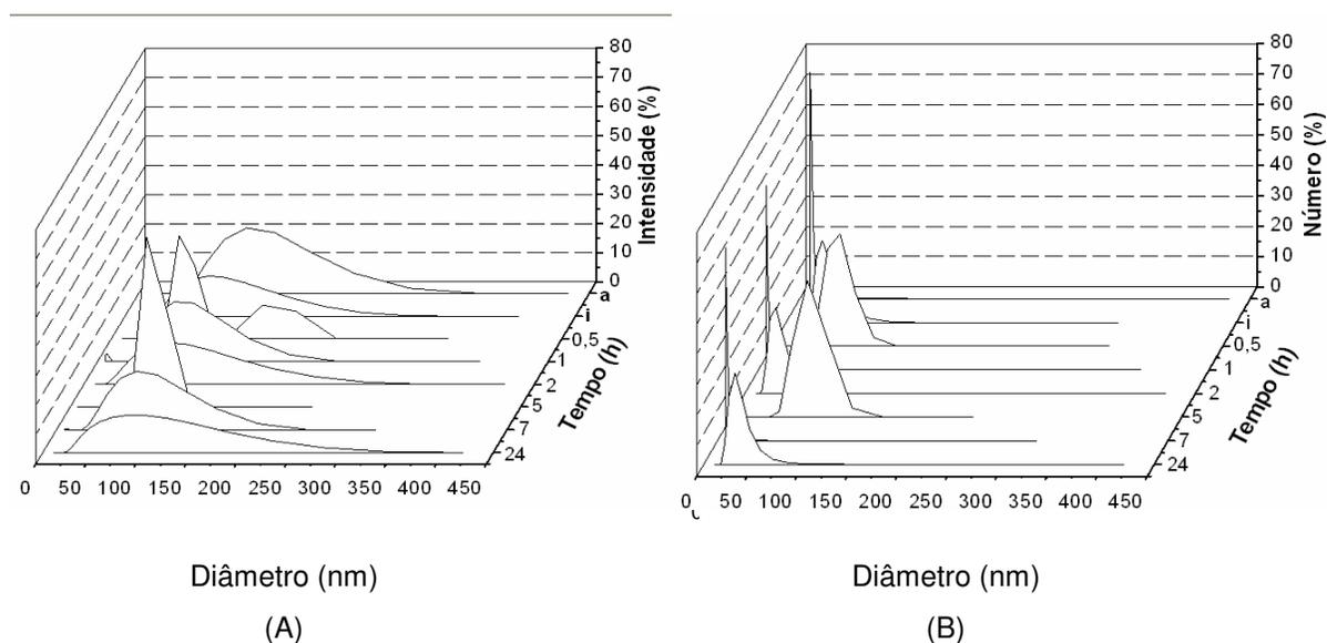
Figura 45 – Influência do tempo no diâmetro e distribuição de tamanhos dos lipossomas elásticos (40 % PEG-8L), após permeação em 20 atm e 37<sup>0</sup> C, durante 24 horas, em termos de (A): intensidade de luz espalhada e (B): número de partículas.
