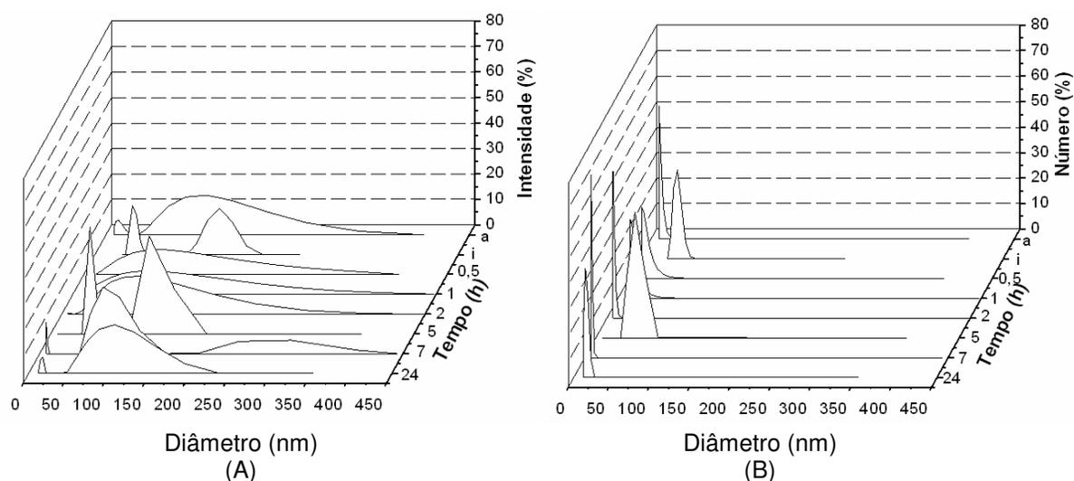
Figura 32 – Influência do tempo no diâmetro e distribuição de tamanhos da solução de PEG-8-L puro, na concentração de  $1.10^{-3} \text{ mol.L}^{-1}$ , em 5,0 atm e  $37^{\circ} \text{ C}$ , durante 24 horas, em termos de (A): intensidade de luz espalhada e (B): número de partículas.
