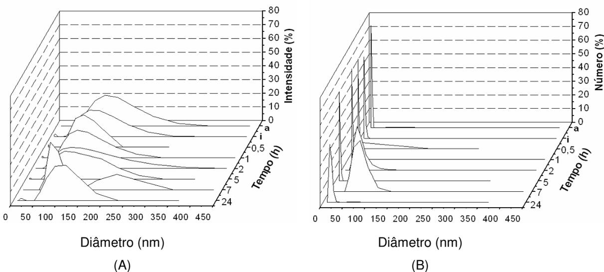
Figura 41 – Influência do tempo no diâmetro e distribuição de tamanhos dos lipossomas elásticos (40 % PEG-8L), após permeação em 2,5 atm e 37<sup>0</sup> C, durante 24 horas, em termos de (A): intensidade de luz espalhada e (B): número de partículas.
