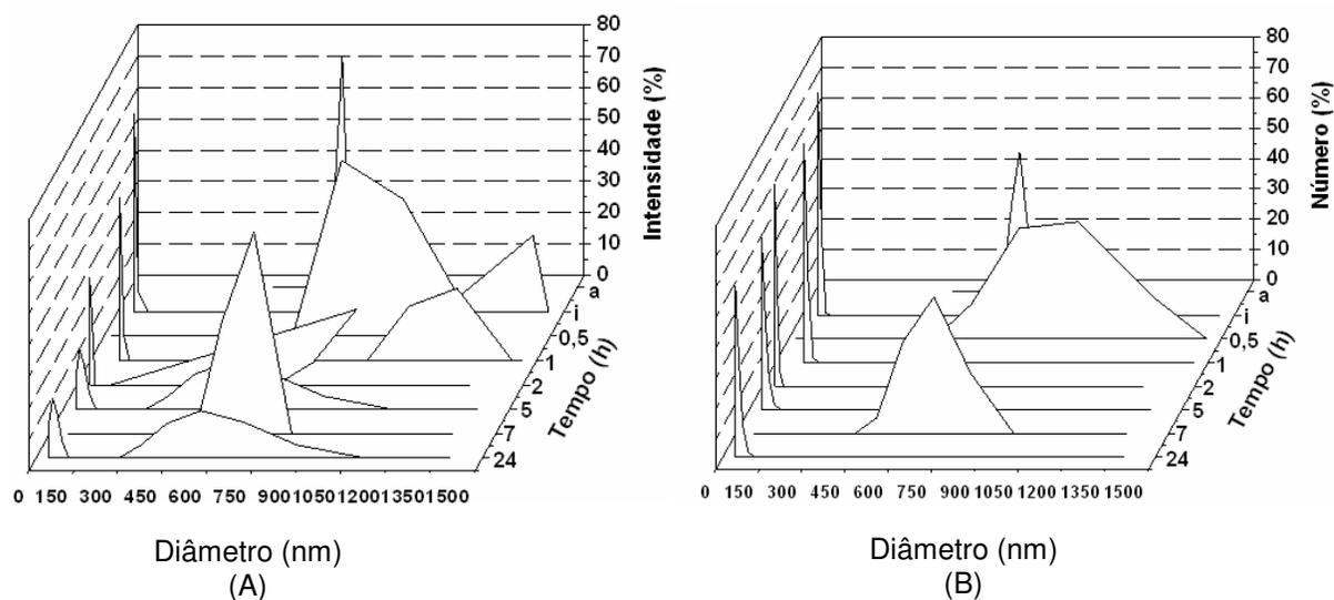
Figura 54 – Influência do tempo no diâmetro e distribuição de tamanhos de cafeína pura em água, com concentração  $1.10^{-4} \text{ mol.L}^{-1}$ , após permeação em 5 atm e  $37^{\circ} \text{ C}$ , durante 24 horas, em termos de (A): intensidade de luz espalhada e (B): número de partículas.
