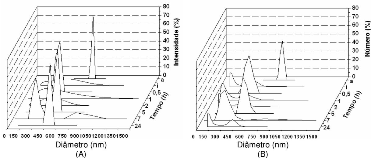
Figura 53 – Influência do tempo no diâmetro e distribuição de tamanhos de cafeína pura em água, com concentração  $1 \cdot 10^{-4} \text{ mol} \cdot \text{L}^{-1}$ , após permeação em 2,5 atm e  $37^{\circ} \text{C}$ , durante 24 horas, em termos de (A): intensidade de luz espalhada e (B): número de partículas.
