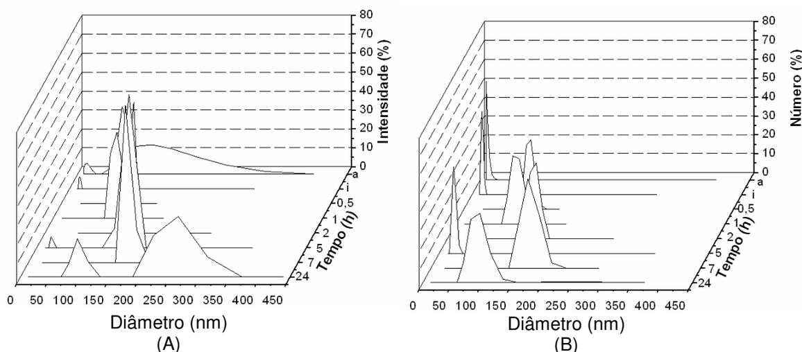
Figura 31 – Influência do tempo no diâmetro e distribuição de tamanhos da solução de PEG-8L puro, na concentração de  $1.10^{-3} \text{ mol.L}^{-1}$ , após permeação em 2,5 atm e  $37^{\circ} \text{ C}$ , durante 24 horas, em termos de (A): intensidade de luz espalhada e (B): número de partículas.
