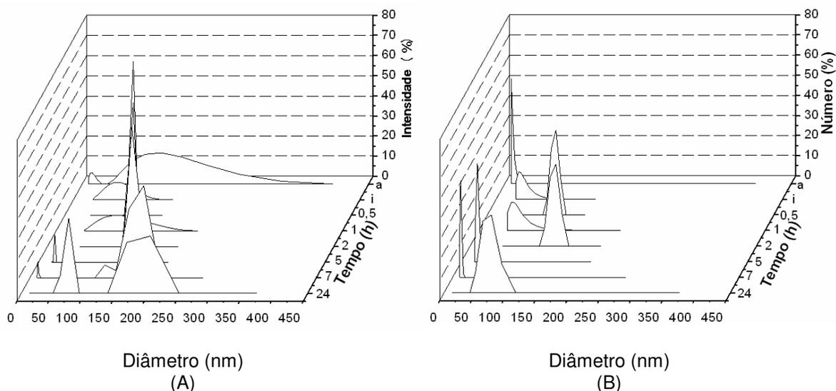
Figura 34 – Influência do tempo no diâmetro e distribuição de tamanhos da solução de PEG-8-L puro em solução, na concentração de  $1.10^{-3} \text{ mol.L}^{-1}$ , em 18 atm e  $37^{\circ} \text{ C}$ , durante 24 horas, em termos de (A): intensidade de luz espalhada e (B): número de partículas.
