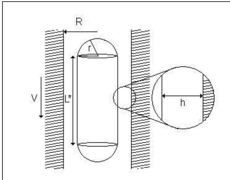
Figura 14 - Representação de uma vesícula esfero-cilíndrica de comprimento  $L^*$  e raio  $r$ , movendo-se com velocidade  $V$  e separada da parede do poro de raio  $R$  por uma camada de lubrificação de espessura  $h$  (Adaptado de Hunter e Frisken, 1998).
