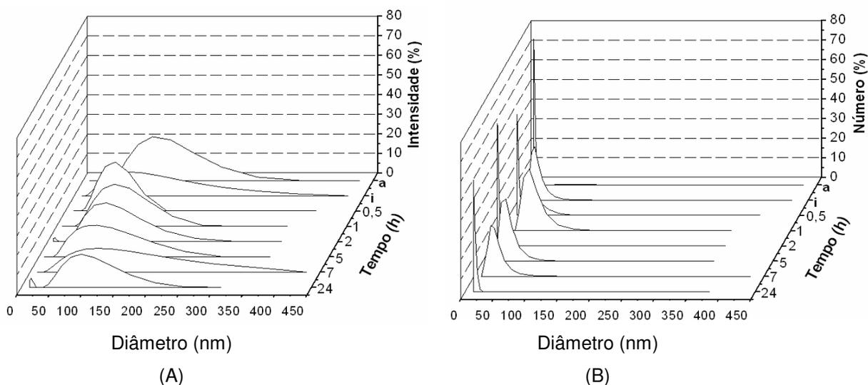
Figura 44 – Influência do tempo no diâmetro e distribuição de tamanhos dos lipossomas elásticos (40 % PEG-8L), após permeação em 18 atm e 37<sup>0</sup> C, durante 24 horas, em termos de (A): intensidade de luz espalhada e (B): número de partículas.
