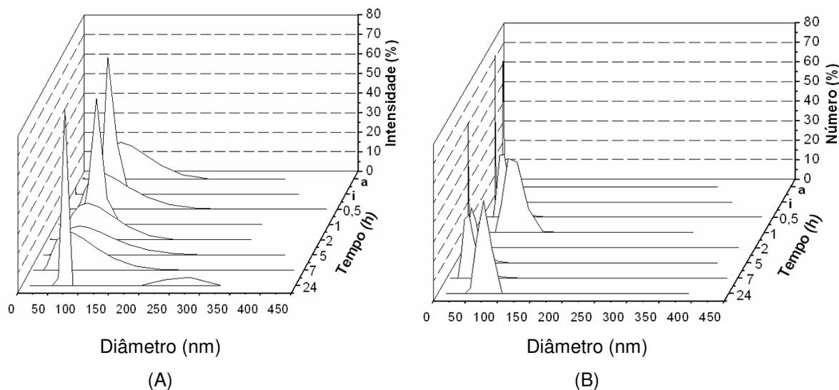
Figura 36 – Influência do tempo no diâmetro e distribuição de tamanhos dos lipossomas elásticos (25 % PEG-8L), após permeação em 2,5 atm e 37<sup>o</sup> C, durante 24 horas, em termos de (A): intensidade de luz espalhada e (B): número de partículas.
