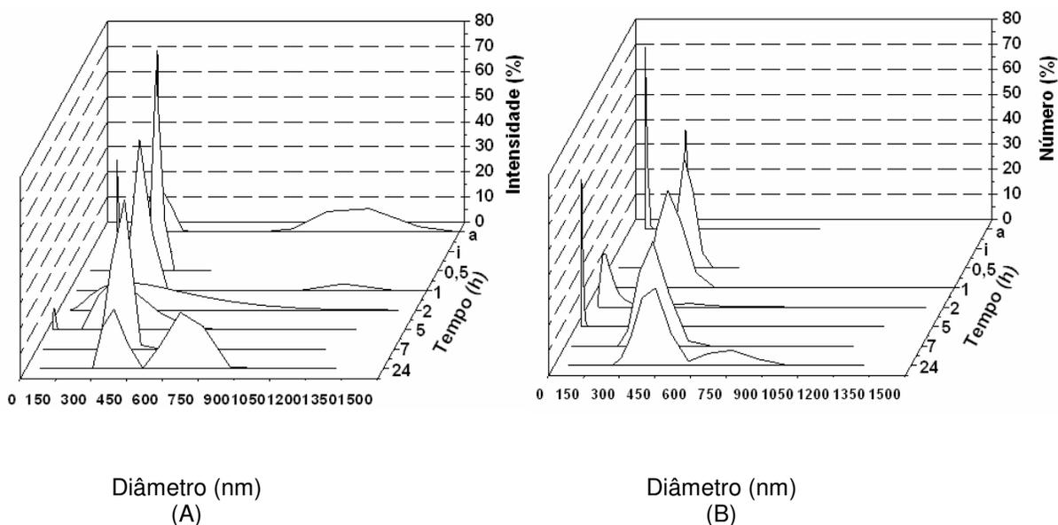
Figura 57 – Influência do tempo no diâmetro e distribuição de tamanhos dos lipossomas elásticos (40 % PEG-8L) incorporando cafeína, para permeação em 20 atm e 37<sup>0</sup> C, durante 24 horas, em termos de (A): intensidade de luz espalhada e (B): número de partículas.
