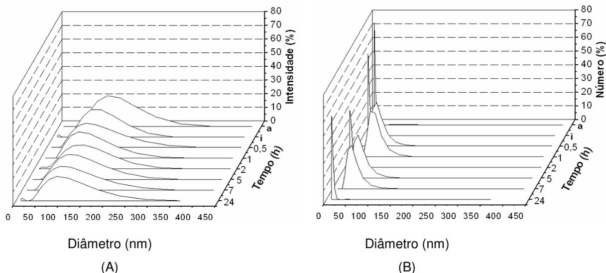
Figura 42 – Influência do tempo no diâmetro e distribuição de tamanhos dos lipossomas elásticos (40 % PEG-8L), após permeação em 5 atm e 37<sup>0</sup> C, durante 24 horas, em termos de (A): intensidade de luz espalhada e (B): número de partículas.
