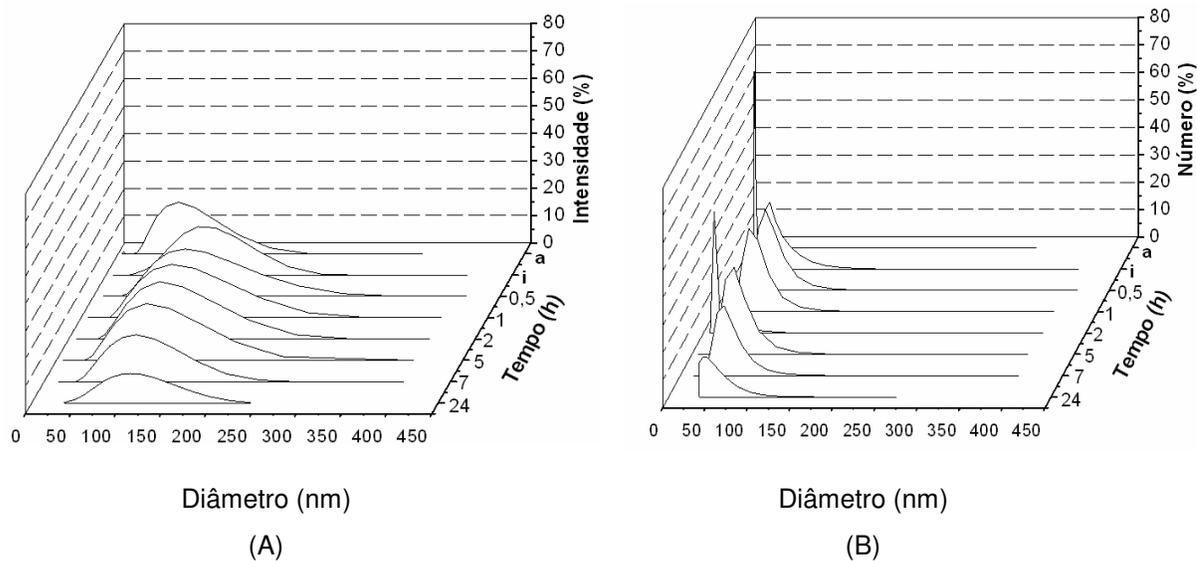
Figura 37 – Influência do tempo no diâmetro e distribuição de tamanhos dos lipossomas elásticos (25 % PEG-8L), após permeação em 5 atm e 37<sup>0</sup> C, durante 24 horas, em termos de (A): intensidade de luz espalhada e (B): número de partículas.
