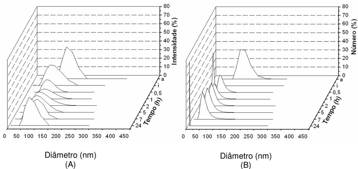
Figura 28 – Influência do tempo no médio e distribuição de tamanhos das vesículas lipídicas, após permeação em 12 atm e 37<sup>0</sup> C, durante 24 horas, em termos de (A): intensidade de luz espalhada e (B): número de partículas.
