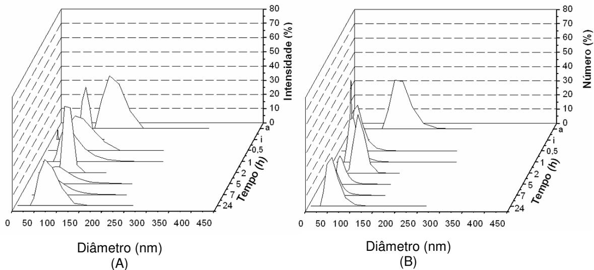
Figura 29 – Influência do tempo no diâmetro e distribuição de tamanhos das vesículas lipídicas, após permeação em 18 atm e 37<sup>o</sup> C, durante 24 horas, em termos de (A): intensidade de luz espalhada e (B): número de partículas.
