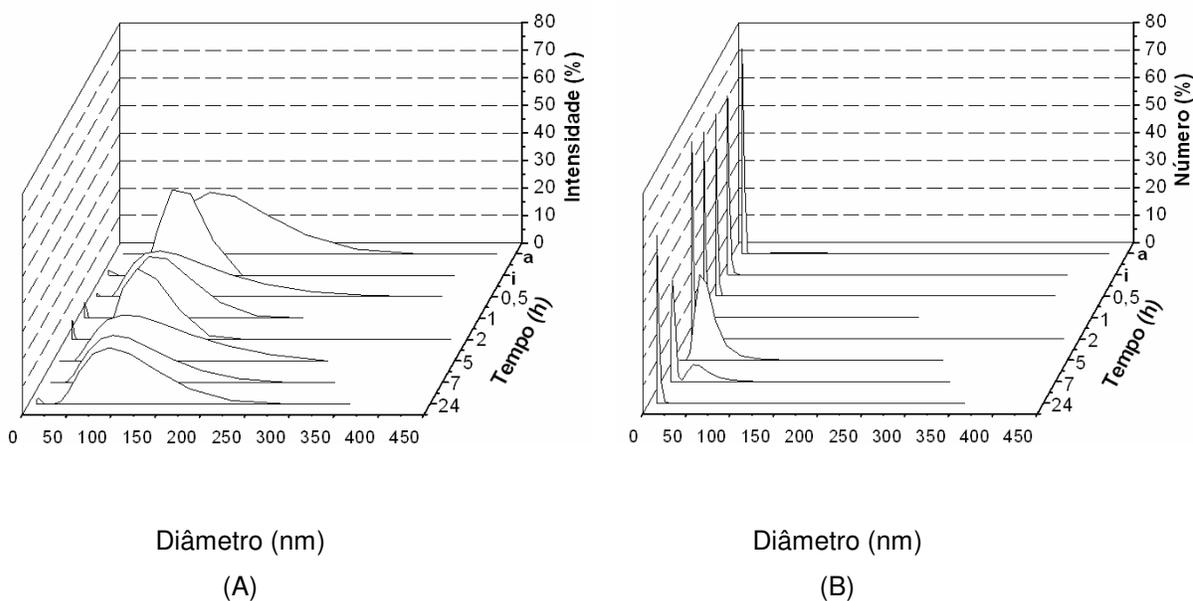
Figura 43 – Influência do tempo no diâmetro e distribuição de tamanhos dos lipossomas elásticos (40 % PEG-8L), após permeação em 12 atm e 37<sup>0</sup> C, durante 24 horas, em termos de (A): intensidade de luz espalhada e (B): número de partículas.
