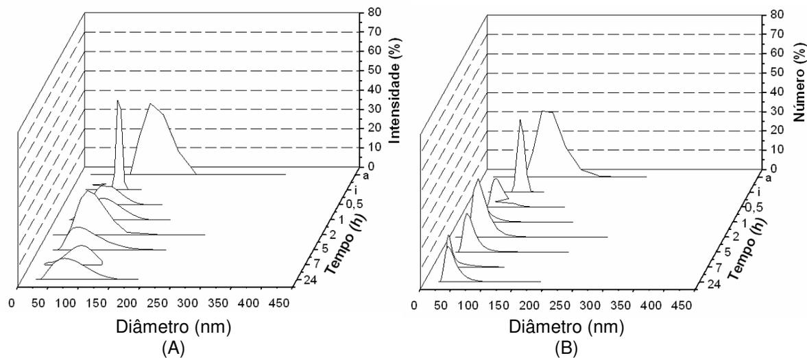
Figura 30 – Influência do tempo no diâmetro e distribuição de tamanhos das vesículas lipídicas, após permeação em 20 atm e 37<sup>o</sup> C, durante 24 horas, em termos de (A): intensidade de luz espalhada e (B): número de partículas.
