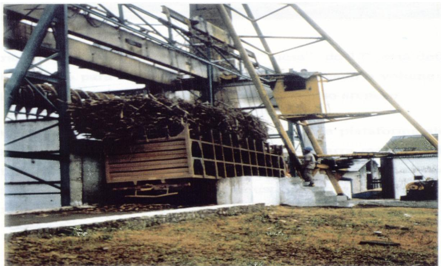
Figura 3.3. Guindaste Hilo em operação na Usina Aliança
