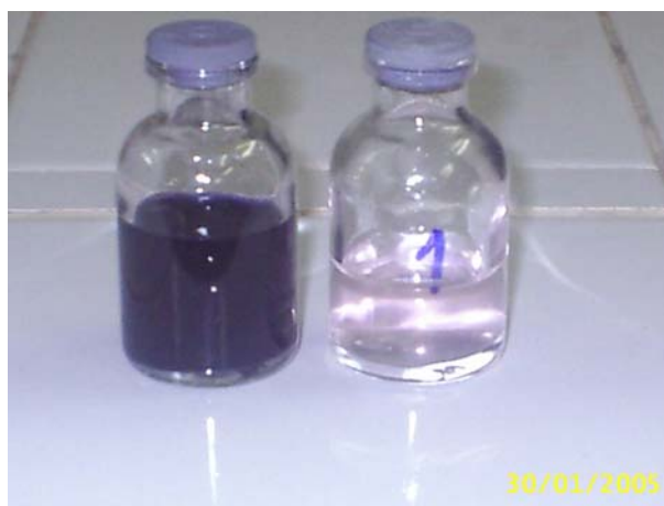
Figura 4.14: Visão da coloração da amostra antes e após a primeira percolação no leito de argila.
