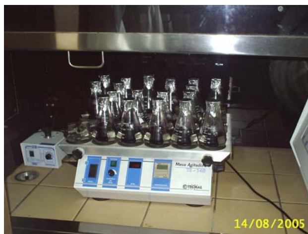
Figura 3.15: Bancada de teste em banho finito.
