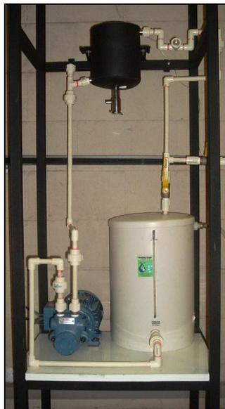
**Figura 1.8: Etapa inicial de montagem do protótipo de transesterificação.**
