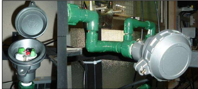
**Figura 1.19 e 1.20: Sensor de temperatura do tipo termoresistência Pt100 e Transmissor de temperatura montado no cabeçote.**
