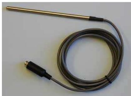
**Figura 1.21 – Pt100 fixado na tampa do reator de biodiesel**
