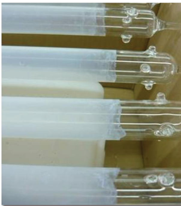
Figura 3.16 – Aspecto da superfície dos tubos após os processos de deposição da superfície P25/TiO 2 /SiO 2 .
