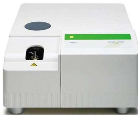
Figura 3.3. Foto do Calorímetro diferencial de varredura DSC 823e.
