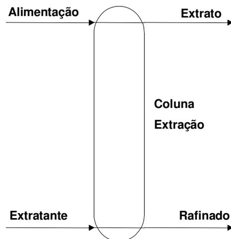
**Figura VI.9:** Diagrama ilustrativo do processo de extração líquido-líquido.
