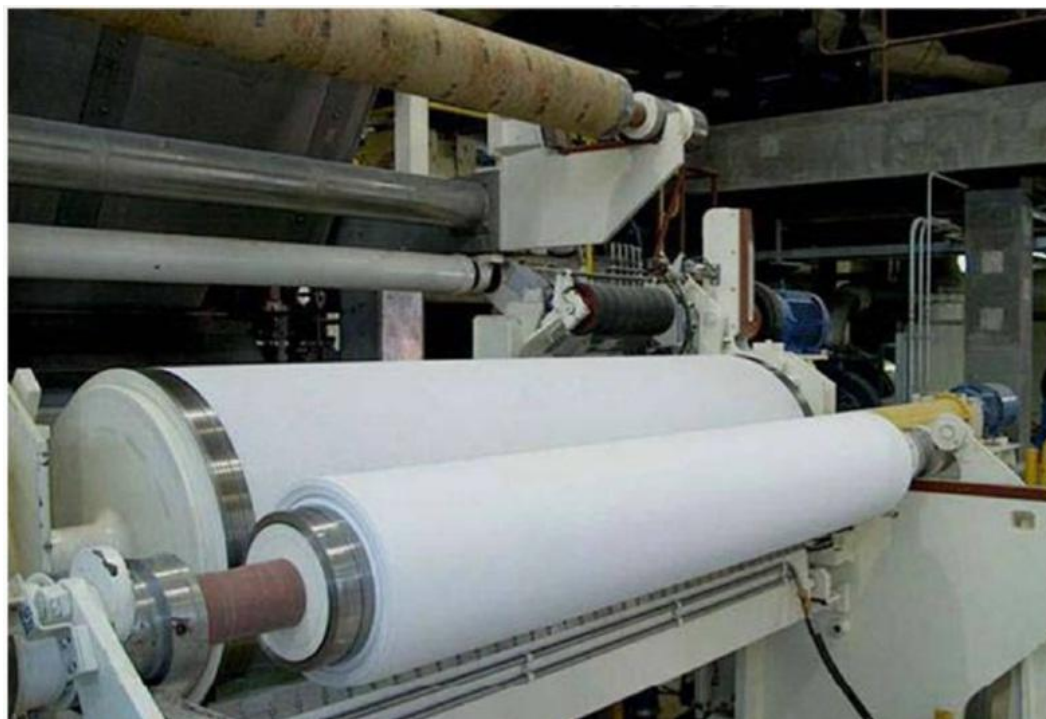
Figura 27 – Exemplo de uma enroladeira com início de enrolamento do rolo jumbo (ARAÚJO, 2010).
