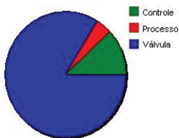
Figura 39 – Gráfico de pizza do Sindus OPP com distribuição percentual dos problemas relacionados ao controle, processo e válvula da malha de controle de nível do tanque de água fresca (LIC038).
