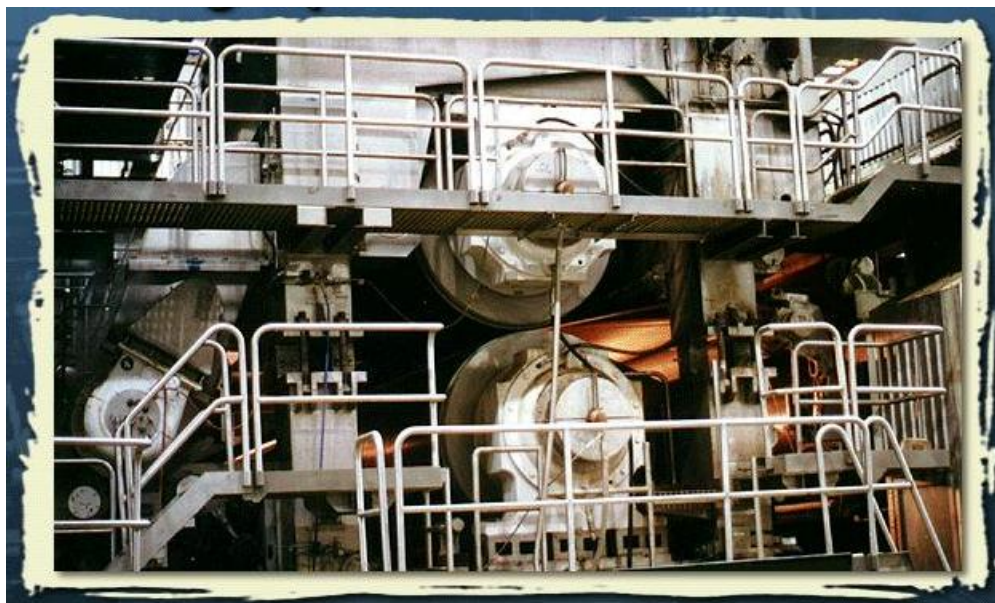
Figura 22 – Exemplo de uma prensa na máquina de papel (TAPPI, 1997).
