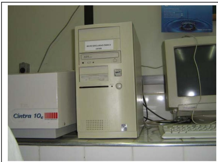
Figura 3.15: Espectrofotômetro UV-VIS disponível no Laboratório de Desenvolvimento de Processos de Separação (LDPS/FEQ/UNICAMP).
