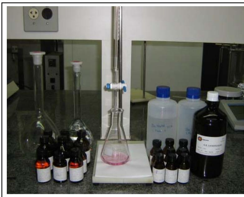
Figura 3.7: Materiais e reagentes para a determinação de AGL.
