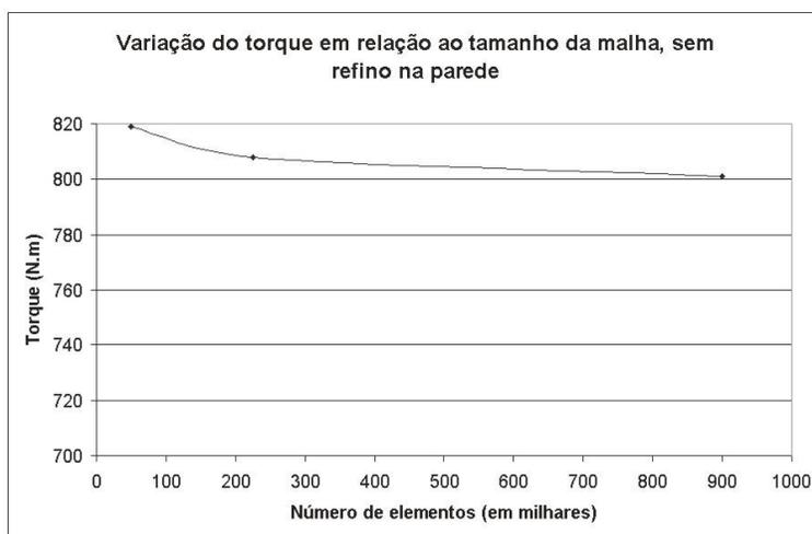
Figura 3.14: Variação do torque em relação ao número de elementos da malha, sem refino na parede.
