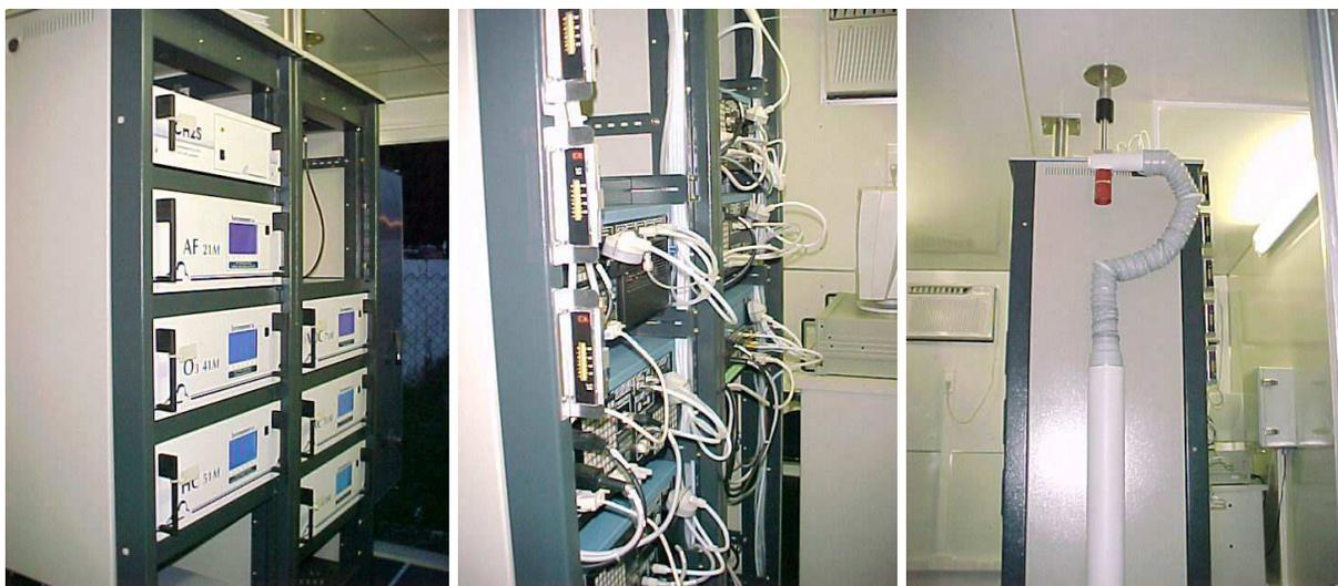
**Figura 43 – Visão interna dos containeres e manifold - Sistema de coleta de ar.**
