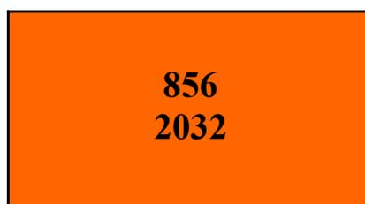
Figura 40 – Painel de segurança para o transporte de ácido nítrico fumegante.
