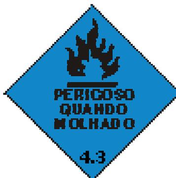
Figura 22 – Rótulo de risco para aplicação no transporte de substância incompatível com água.
