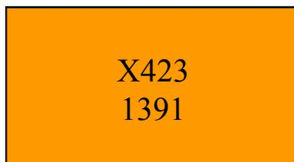
Figura 23 – Painel de segurança para aplicação no transporte de metais alcalinos, dispersões ou metais alcalinos não terrosos, dispersões.
