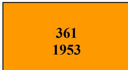
Figura 13 – painel de segurança para transporte de gases inflamáveis, tóxicos, comprimidos ou liquefeitos.
