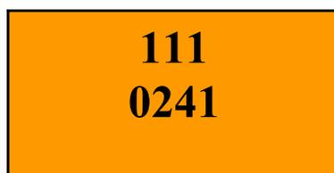
Figura 7 – Painel de segurança para explosivo de demolição tipo E.
