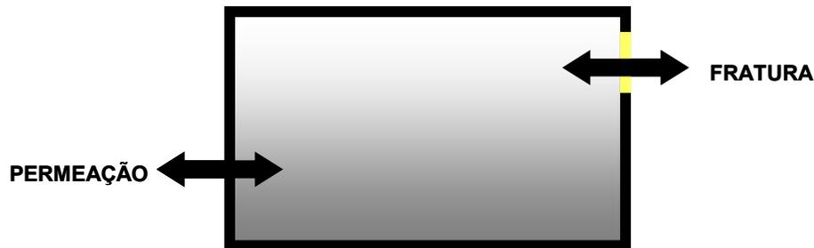
**Figura 4.** Processos pelos quais gases e vapores passam através de embalagens (SARANTÓPOULOS, 2007).
