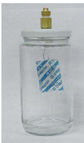
**Figura 14.** Célula de absorção contendo um sachê absorvedor de oxigênio
