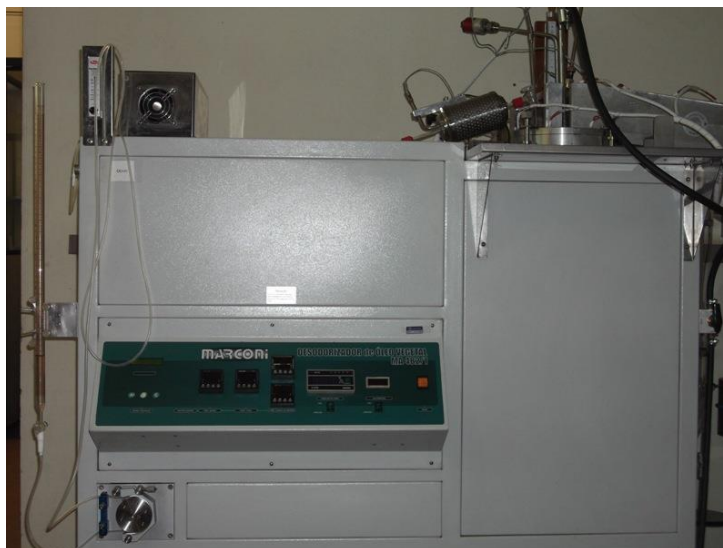
Figura 4.14. Visão geral do equipamento desodorizador.
