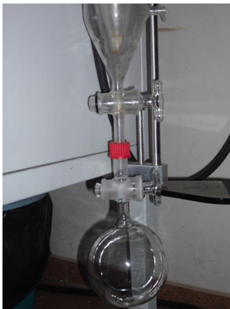
Figura 4.12. Balão Coletor de destilados (sigla (q) na Figura 4.2).
