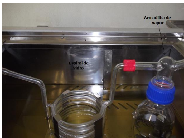
Figura 4.10. Espiral de vidro e Armadilha de vapor (siglas (c,g) na Figura 4.2).
