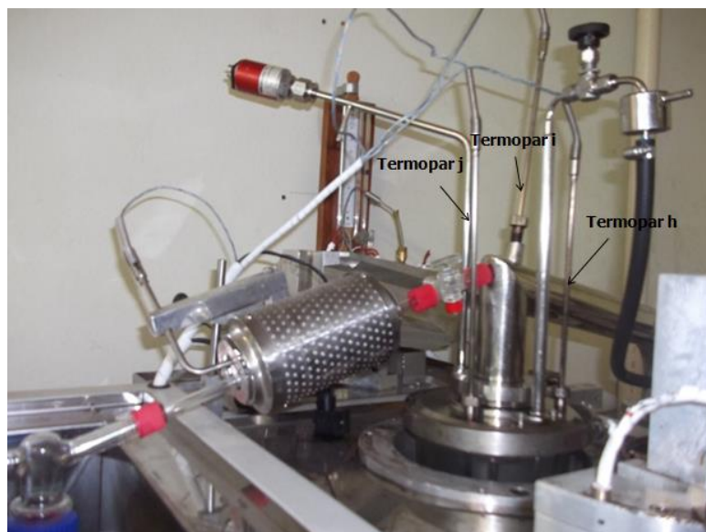
Figura 4.5. Termopares (siglas (h, i e j) na Figura 4.2).
