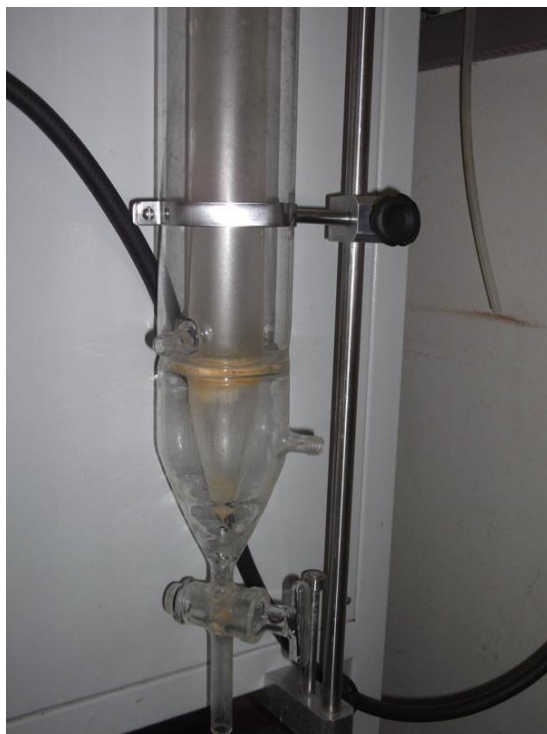
Figura 4.8. Condensador (sigla (p) na Figura 4.2).
