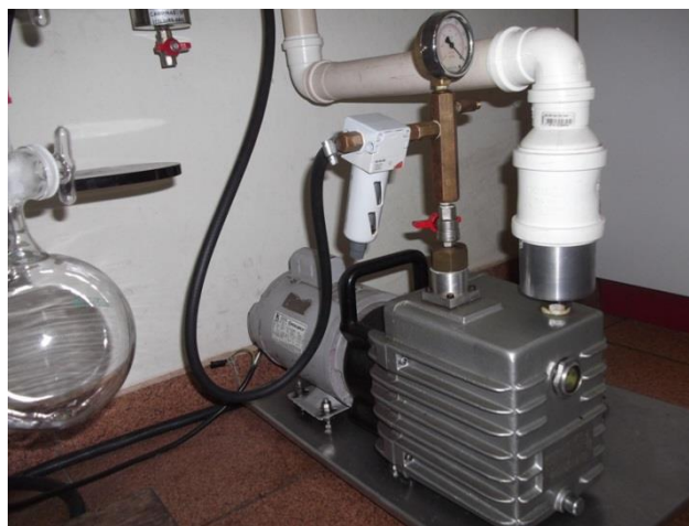
Figura 4.13. Bomba de vácuo (sigla (s) na Figura 4.2).
