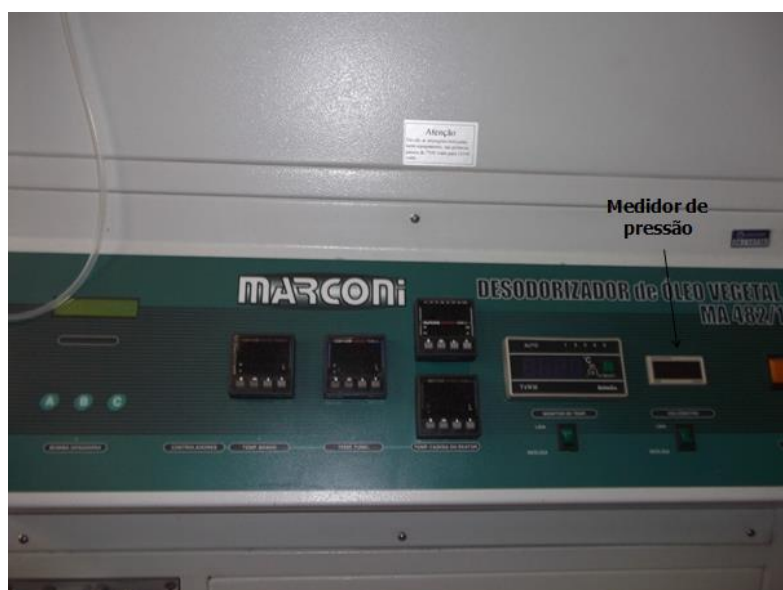
Figura 4.6. Medidor de pressão através de um manômetro.
