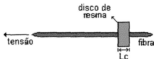
Figura 17: Representação do molde na forma de botão com comprimento crítico ( $L_c$ ) e do “pull out” (YUSOMOYA e col,1990).
